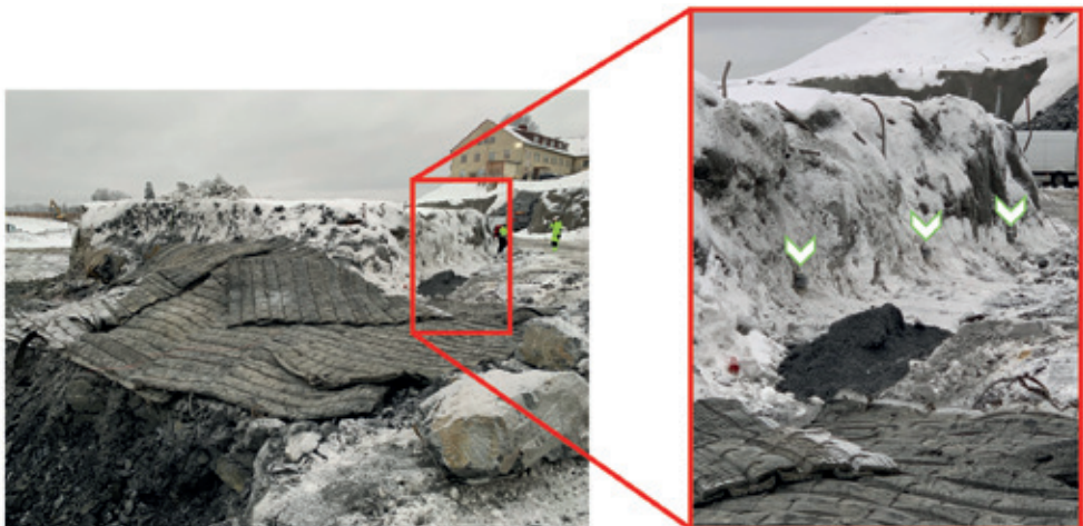
Figur 6: Oppsett med sprengningsområde og utplasserte rystelsesmålere på 5, 10 og 15 m avstand (Mofoss, 2025).
