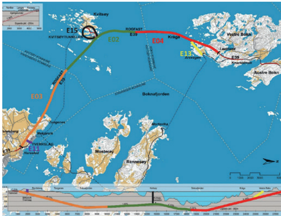
Figur 1 Oversiktskart og lengdeprofil av E39 Rogfast med oppdeling av tunnelkontrakter. Illustrasjon laget av Norconsult. E11 Adkomst Mekjarvik 2018 Hæhre. E13 Adkomst Arsvågen 2018-2019 NCC Norge AS. E15 Kviteseidtunnelen 2021-2024 JV Hæhre/Risa. Pågående kontrakter; E04 - Bokn Skanska oppstart januar 2023. E03 Mekjarvik JVIS (Implenia Norge AS og Stangeland Maskin AS) oppstart januar 2023. E02 Kviteseid Oppstart august 2025 JVIS (Implenia Norge AS og Stangeland Maskin AS).
