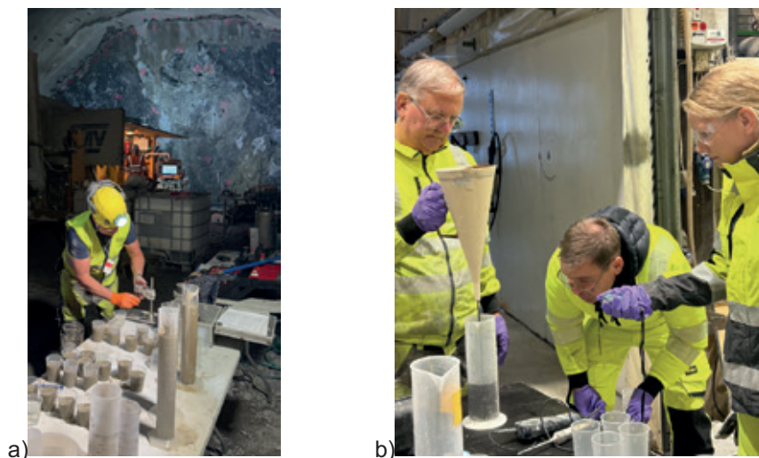
Figur 1: a) Master Builder Solutions tester materialegenskaper under pilot av injeksjonsmasse med sementerstatter på E18 Vestkorridoren (foto: Helene Strømsvik) og b) fullskala landing av alkali-aktivert injeksjonsmasse hos Veidekke (foto: Sigrun Nilsen).
