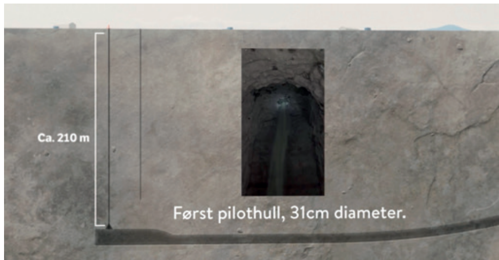
Figur 9 Boring av pilothull.
