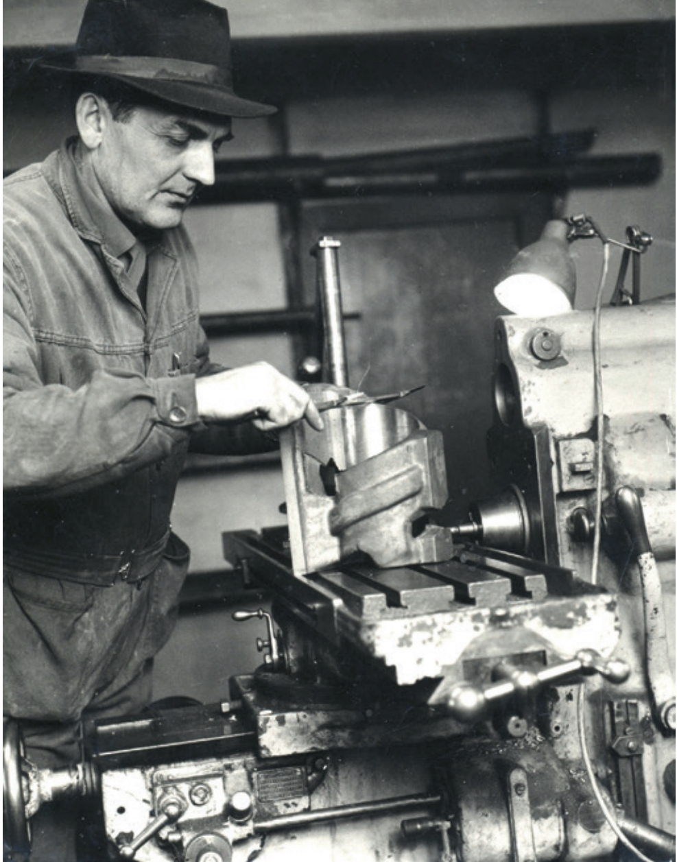
Peder Andersen justerer formhode til Spiro rør (Bilde: AMV)
