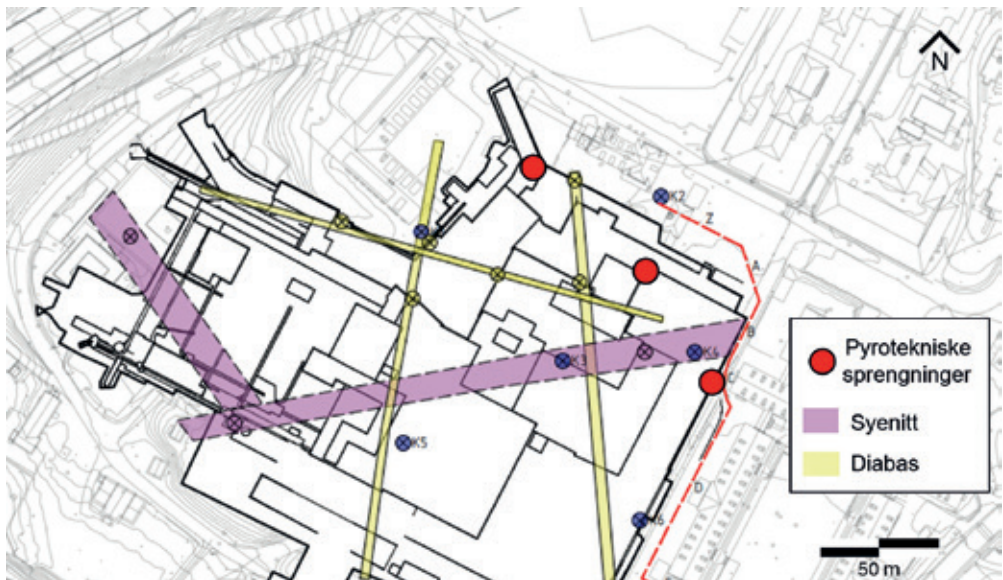
Figur 2: Tolkede bergganger og plassering av pyrotekniske sprengninger. Modifisert fra Rian (2024).
