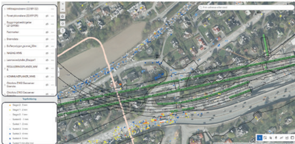
Figur 21 INSAR-målinger fra prosjektet fra 2025. Foreløpig resultater viser mindre setninger og få hevinger.
