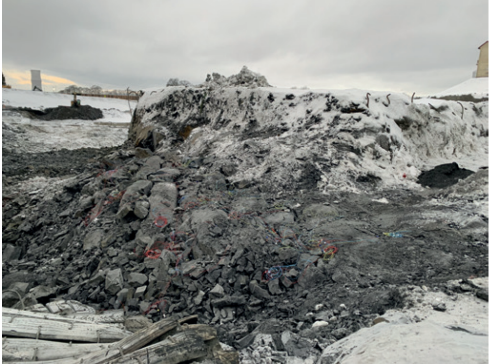
Figur 14: Fragmentering etter pyroteknisk sprengning fra test nr. 2. Større blokker forekommer i toppen av røysa med mindre fraksjoner nedover.
