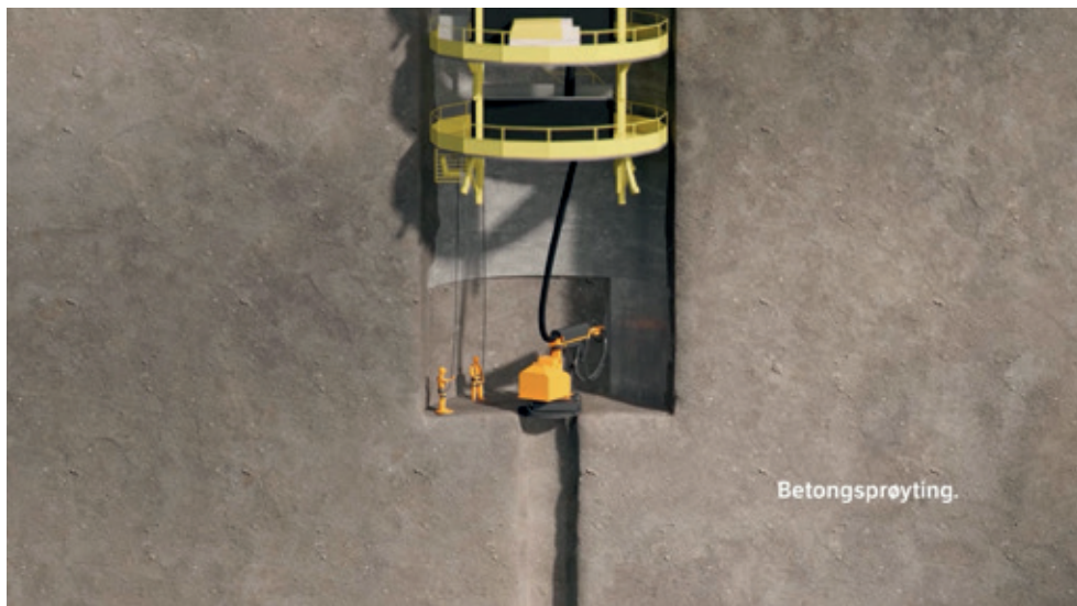
Figur 26: Sprøytebetong. Betong føres ned fra betongbil på overflaten i rør med selvfall ned til arbeidsplattformen, Der står betongpumpe og pumper til den spesialbygde sprøyteriggen
