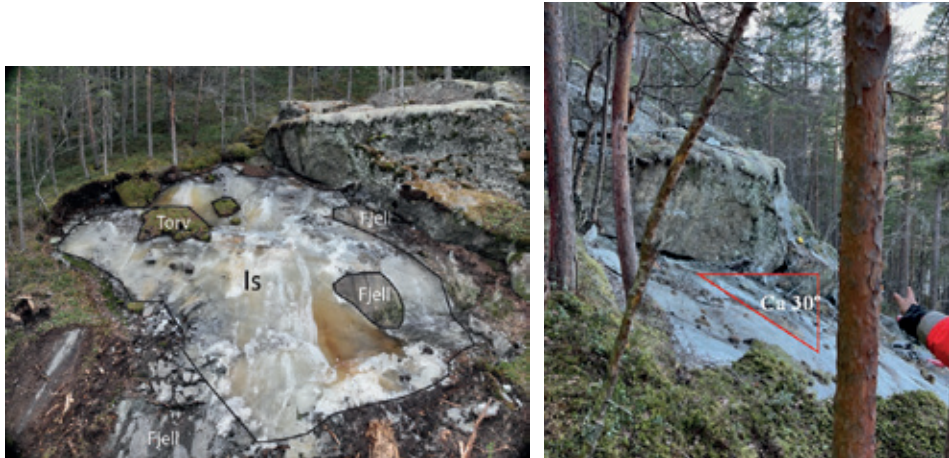
Figur 6. Fotografier av løснеområdet med glideflate og gjenstående blokk i bakkant; a) Bilde tatt 31.3.2025 av Marius Grøndal, SVV, b) Bilde tatt 7.4.2025 av ekspertutvalget v/Martina Böhme.
