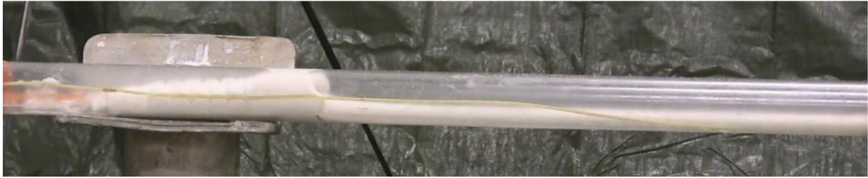
Slakk på ladeslangen mot slangetrekket må ikke forekomme. Da kan dette oppstå, bildet viser. lading med slangetrekk i plexiglass (50mm) som skal illustrere et konturhull der det har vært slakk på ladeslangen.
