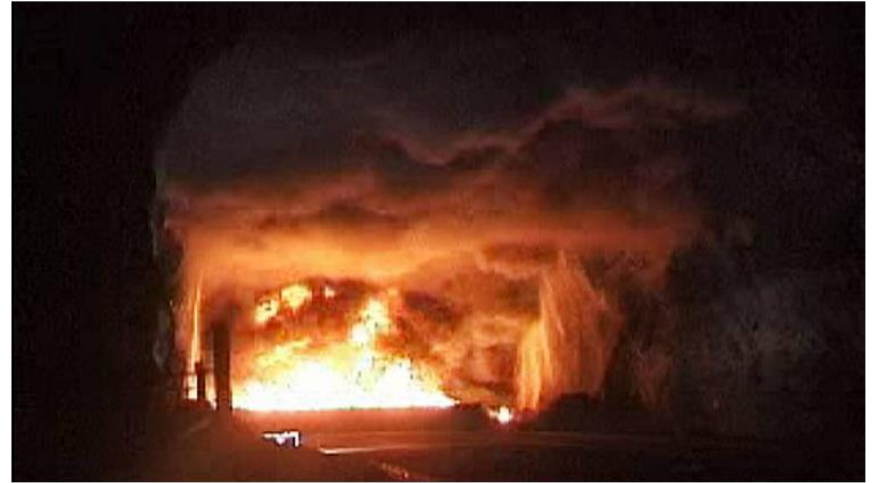
Bildet stammer fra Statens Vegvesen sin test av PE-skumplater. Les mer om testen lengre ned i saken.
