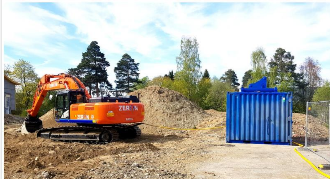
Den ombygde Hitachi-maskinen i arbeid. Den originale dieselvarianten trenger 10 liter diesel i timen, det tilsvarer 100 kWt. Maskinen på bildet nøyer seg med 28 kWt. (Foto: NASTA)
