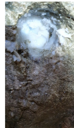
Kolloidal silika i injeksjonshull
