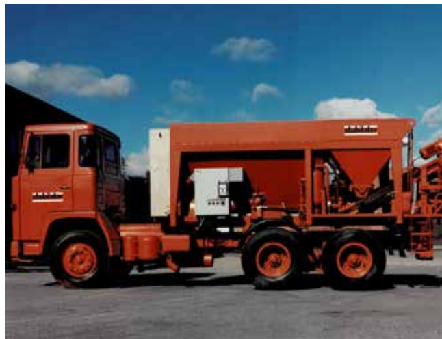
«Trixer» mobilt blandeverk bygget av Stabilator tidlig 70-tall.
