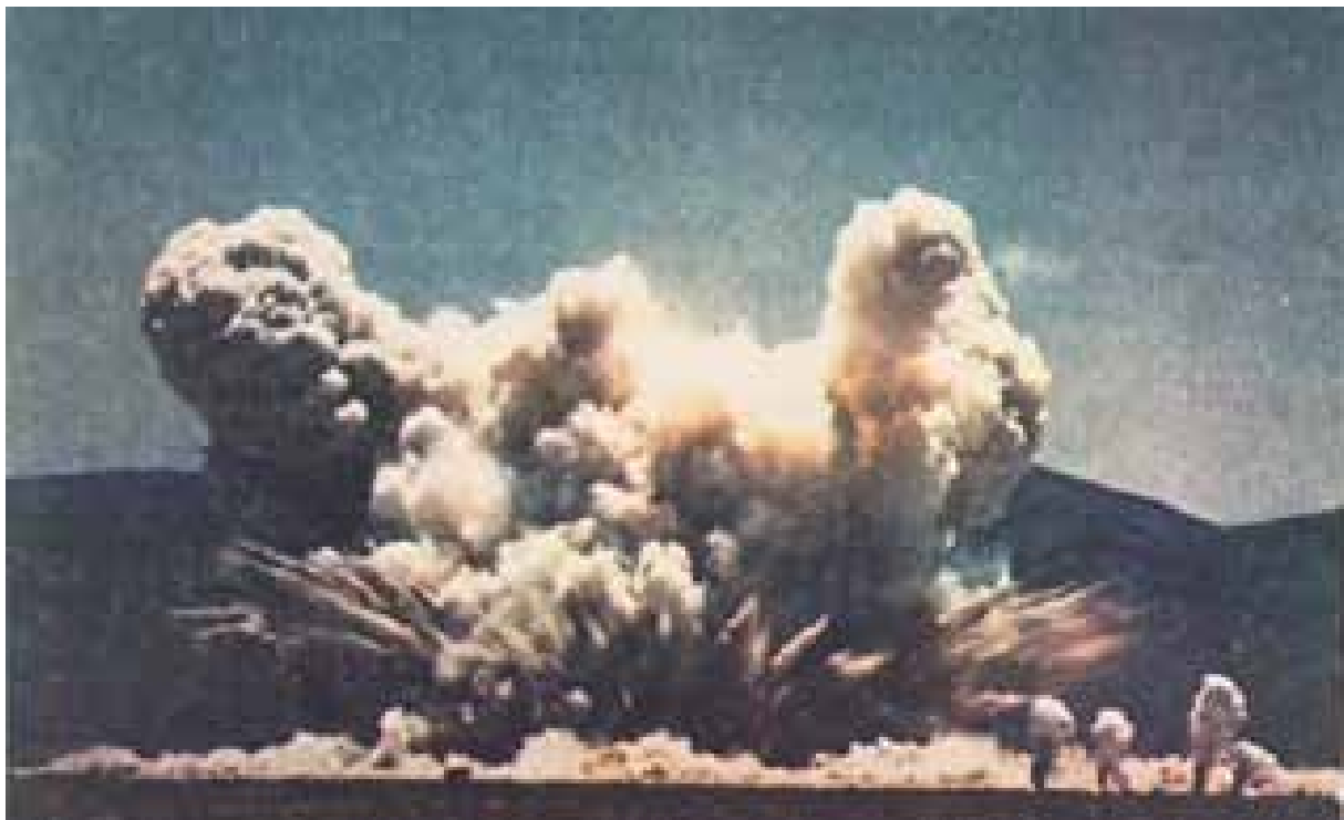
I samarbeide med USA ble norsk fortifikatorisk utstyr testet i full skala. Bildet viser en 8KT ladning frembragt av konvensjonelt sprengstoff. White Sands Missile Range New Mexico
