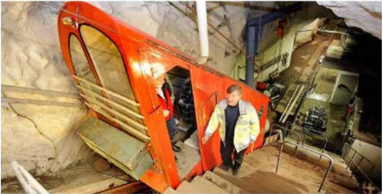
En av vognene med Øistein Saugerud som har vært driftsansvarlig og kjørt banen minst 15000 turer. Her har vognen fått en ekstra kabin for persontransport.
