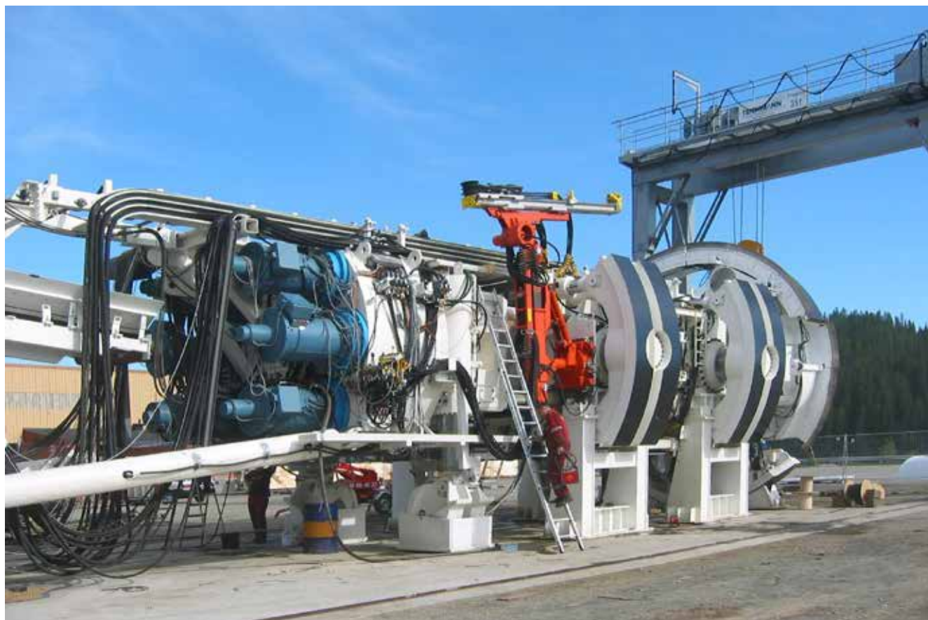
Atlas Copco TBM MK27 under overhaling og diameterutvidelse av NCC International AS i Fosdalen, Malm for bruk på et kraftverksprosjekt i India. Foto: Egil Engesrønning
