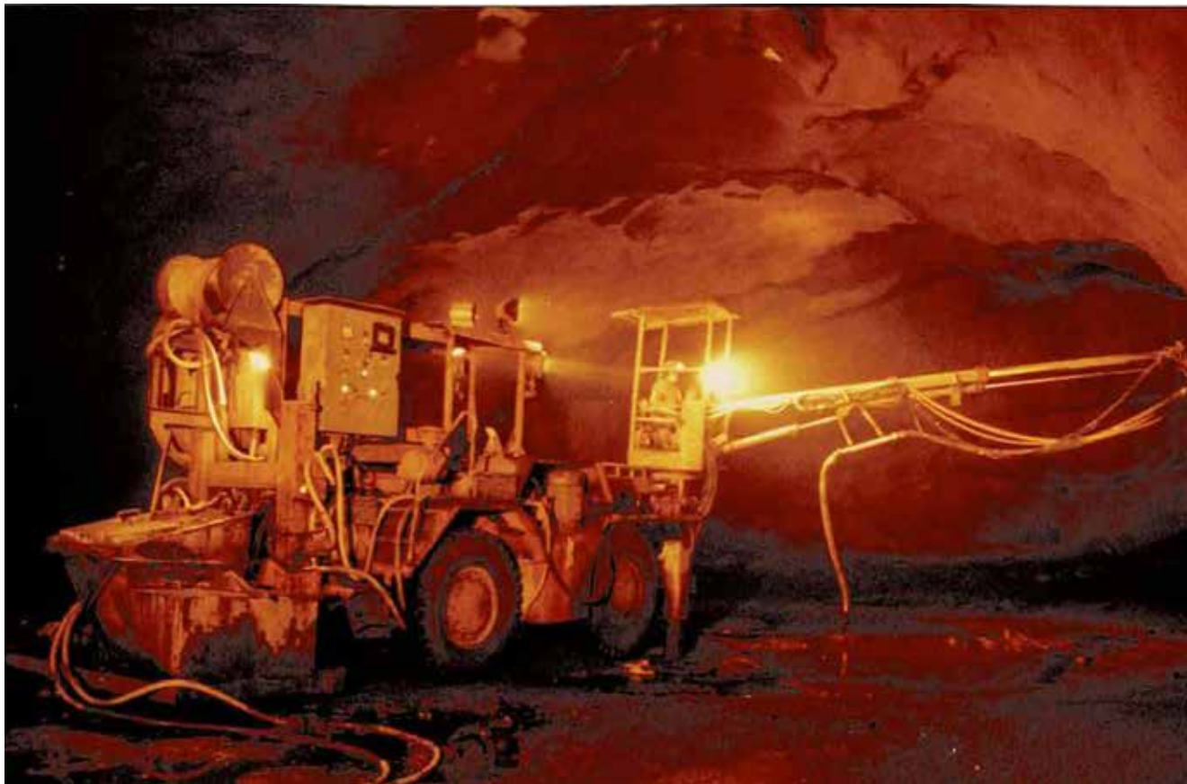
Sprøyterobot bygget på Cat 944 ca. 1978 av Furuholmen/AMV. Foto fra renseanlegget i Slemmestad/Asker
