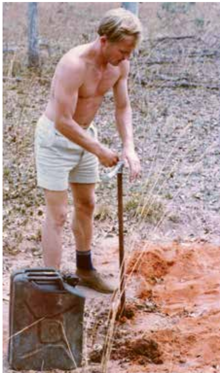
Geotekniker Svein Jørve tar prøver for å finne tetningsmasser til dammen i Stiegler's Gorge.
