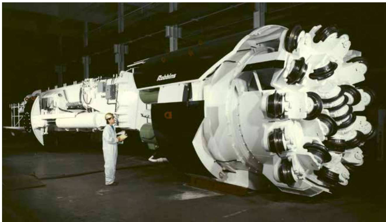
Robbins HP TBM 1215-265, 3,5 m diameter. Foto: The Robbins Co.
