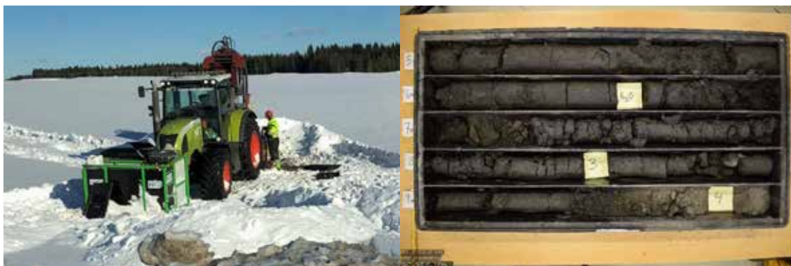
Fig. 2 Borerigg med Sonic Drilling utstyr og borekjerne som ble tatt opp
