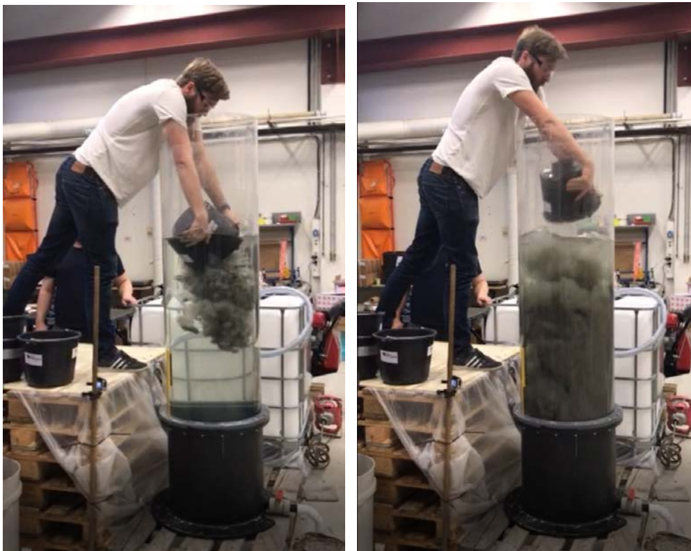
Figur 16. Bilder fra tømning av første bøtte med masse, fra film på utført rørforsøk.
