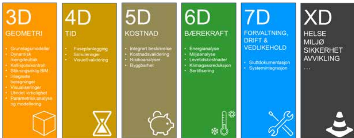
Figur 2 Dimensjoner i fullintegrert BIM - Norconsult
