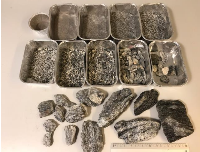
Figur 3. Siktet og vasket TBM-kaks.
