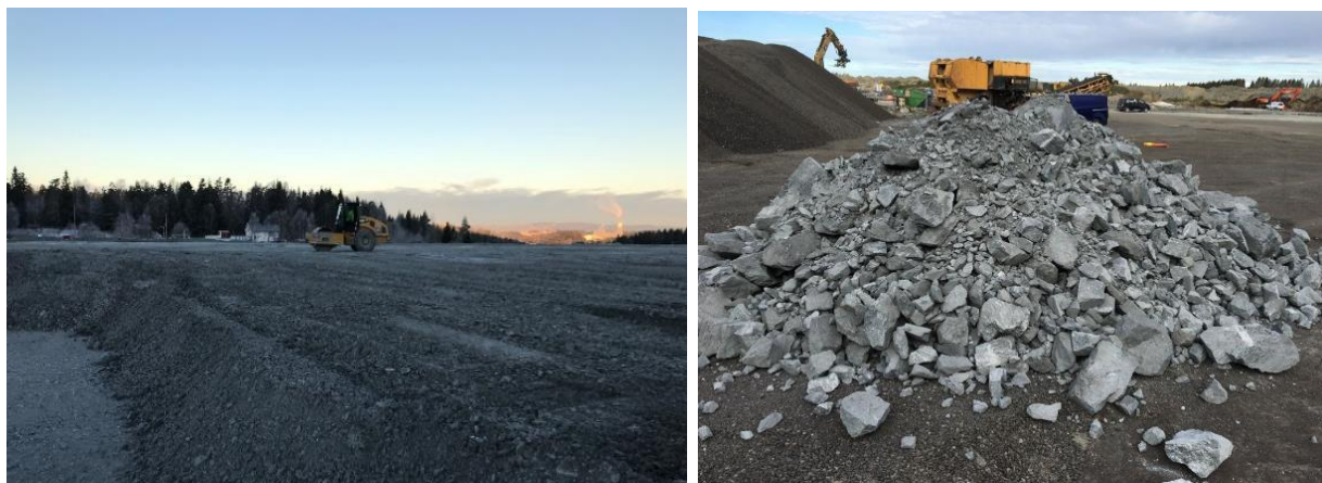
Figur 14. Masser for uttesting TBM-kaks fra fylling ved Follobanen (venstre) og sprengt tunnelstein fra Akershusstranda (høyre).
