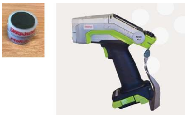
Fig. 6 pXRF pistol og preparert prøvebeholder med nedknust materiale
