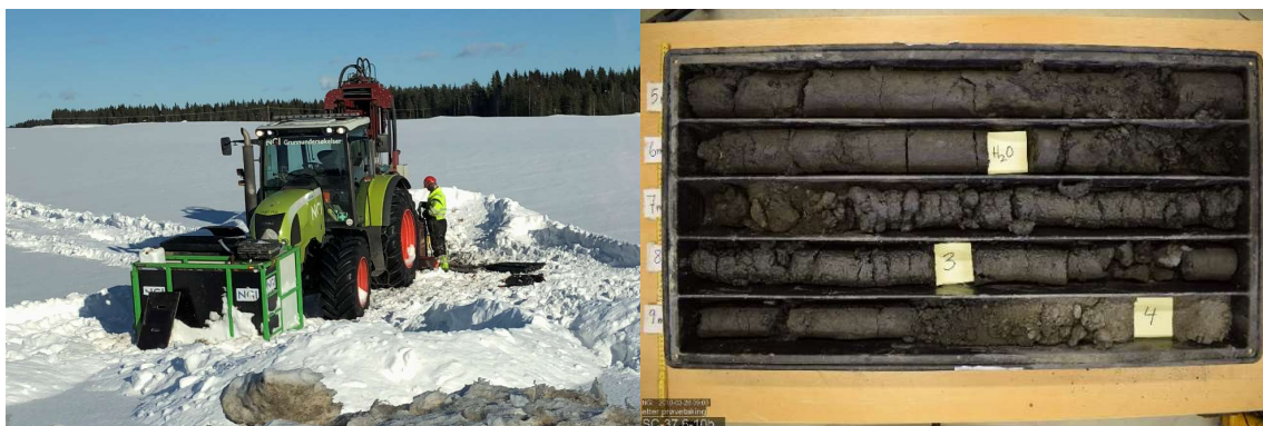
Fig. 2 Borerigg med Sonic Drilling utstyr og borekjerner som ble tatt opp
