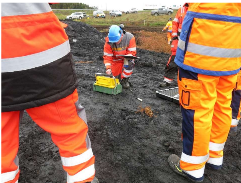
Fig. 9 Troxler-måling for kontroll av komprimeringsgrad
