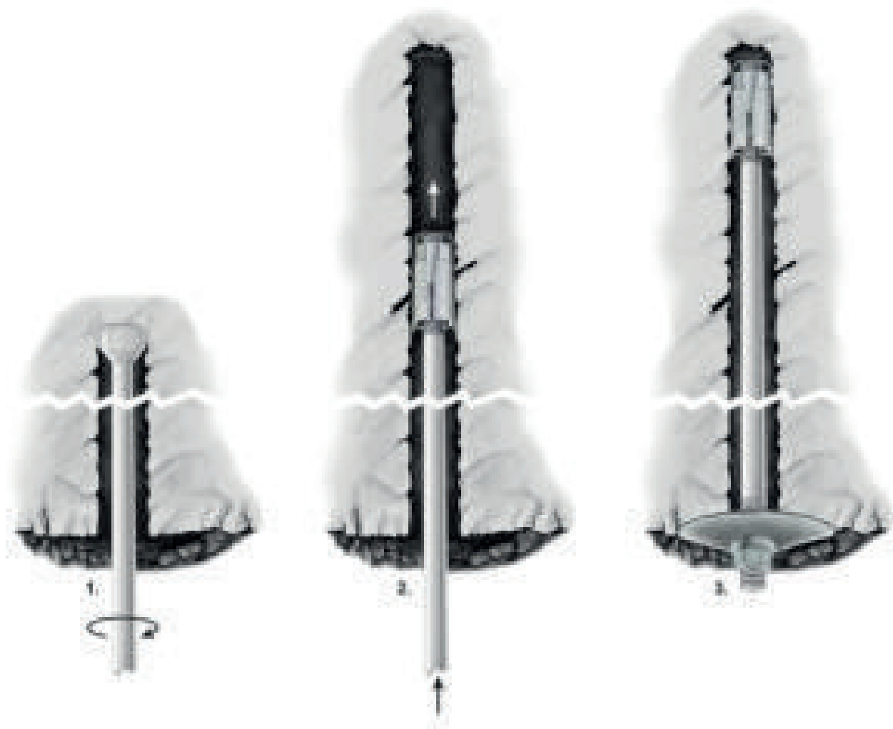
Figur 4.9 Montering av bolt med ekspansjonshylse (endeforankrede bolter).
