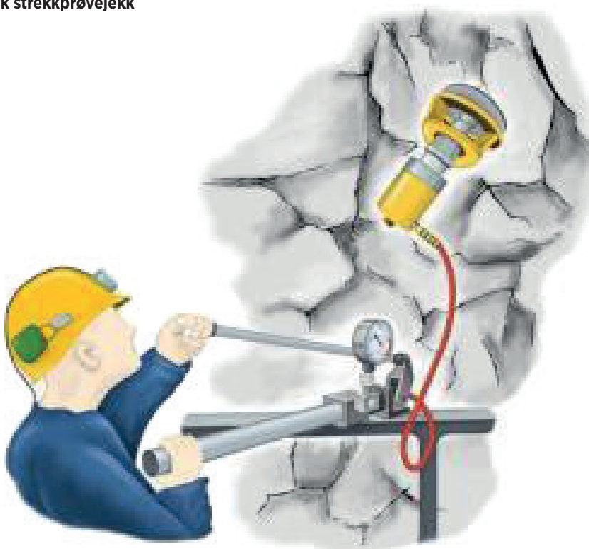
Figur 6.1 Prøvetrekking med hydraulisk strekkprøvejekk
