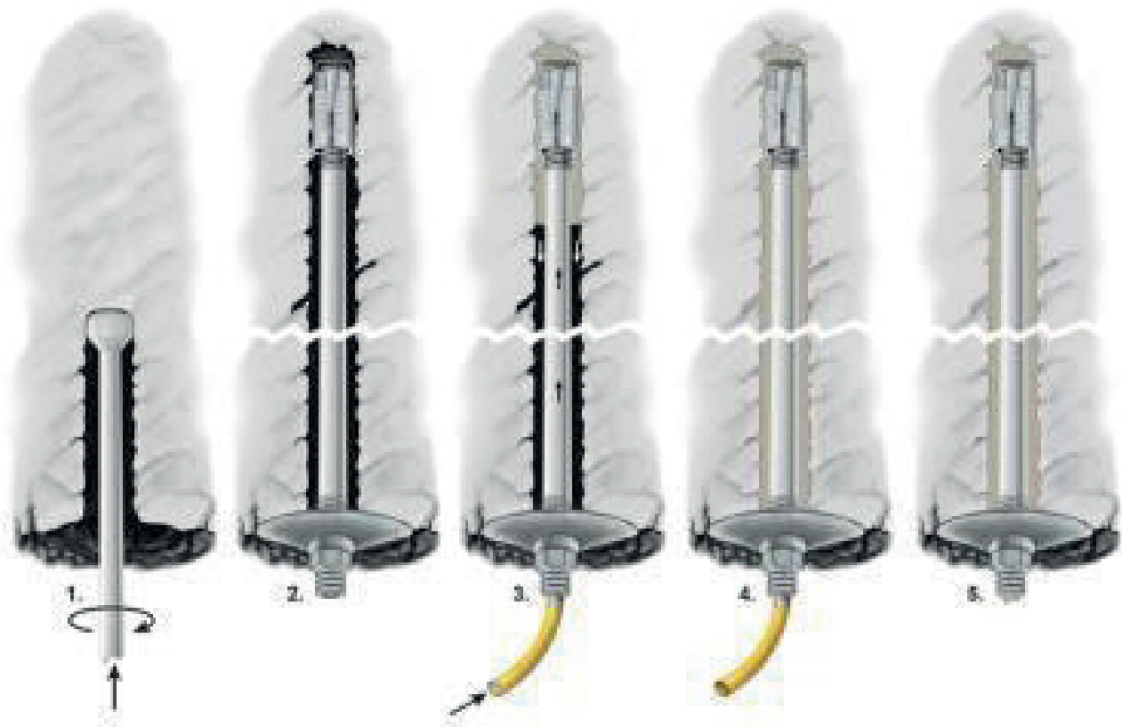
Figur 4.13 Montering av rørbolt
