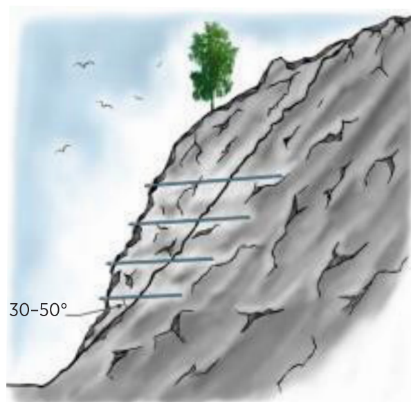
Figur 5.10 Anbefalt vinkel mellom bolt og sprekkeplan
