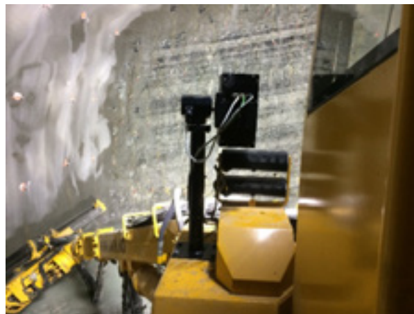
Figur 7.13. Det kan dokumenteres enten med et håndholdt kamera, her et nettbrett (t.v) eller med et fastmontert kamera på en bore- eller sprøyterigg (t.h).
