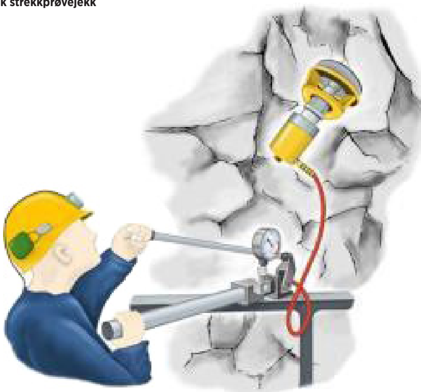
Figur 6.1 Prøvetrekking med hydraulisk strekkprøvejekk
