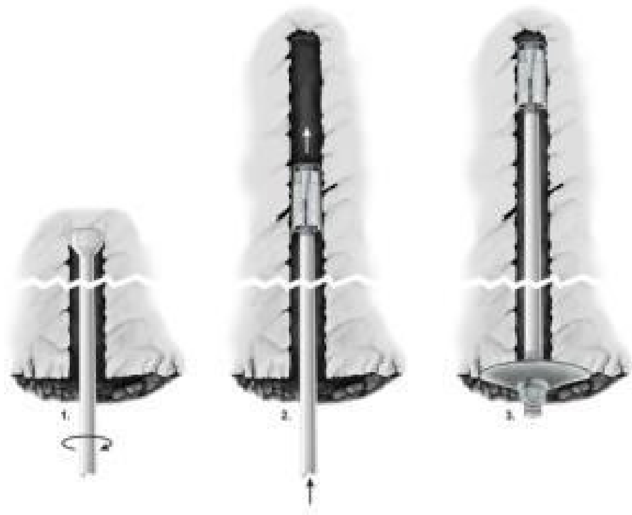
Figur 4.9 Montering av bolt med ekspansjonshylse (endeforankrede bolter).
