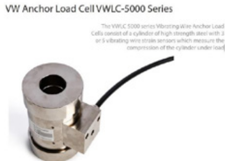
Figur 8: Viser Geosense VWLC-5000 lastcellen som ble benyttet på prosjektet. De to lastcellene som ble benyttet hadde en øvre kalibrert kapasitet på 2500 kN, men er samtidig designet for å håndtere laster opp til 3000 kN.
