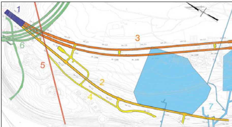
Figur 2: Oversiktskart over tunnelene i nordre del av Ekebergåsen. 1) Tresporshallen, 2) Inngående Østfoldbane, 3) Inngående og Utgående Follobane, 4) Adkomsttunneler og tekniske rom, 5) Alnaelv tunnelen, 6) E6-Ekebergtunnelen, 7) Lagrinshaller for petroleum.
