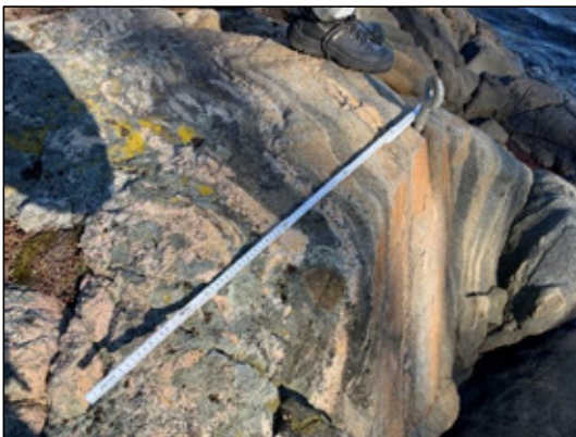
Figur 3: Båndet amfibolittisk gneis i akse 3.
