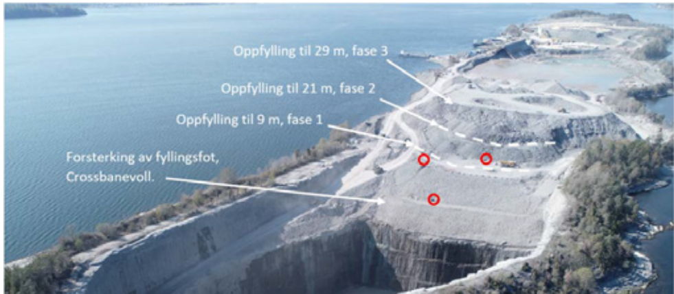
Figur 7 Bildet viser Crossbanevollen og oppfyllingstrinnene i Seksjon 4. Poretrykksmålerene og inklinometermålepunktene er vist med røde ringer.
