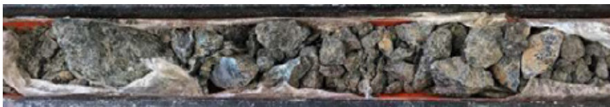
Figur 3: Serpentinit fra BH-2, tilløpstunnel i Moglicë
