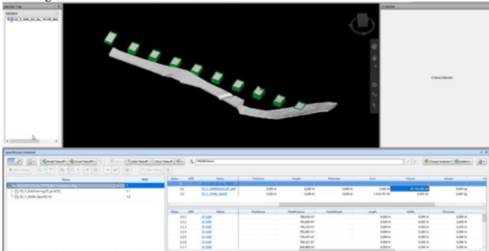
Figur 7: Mengdeberegning i Navisworks for en bru og en vei (kalksementstabilisering vist i grått og spunt vist i grønt).
