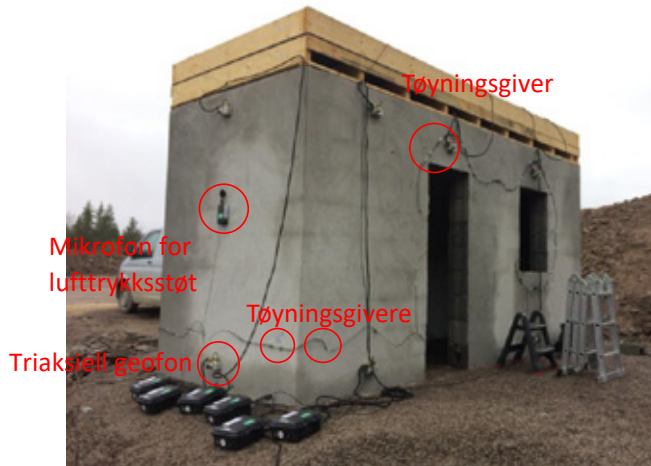
Figur 5. Instrumentering av Lecabygget
