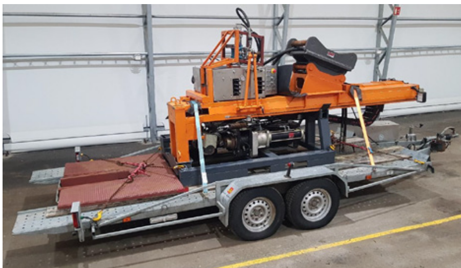
Figur 2 Boretårn klargjort for transport på biltransporthenger. Boretårnet ligger i tilpasset ramme. Arbeidsplattformen ligger bak på hengeren. SMP60 til SMP70 adapter er her påmontert.
