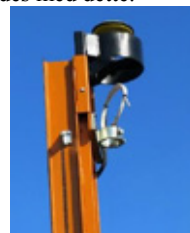
Figur 4 til venstre: Rådata med GPS-koordinater (HX, HY, HZ). HW angir koordinatsystem. "HT GPS Accuracy» er et mål på nøyaktigheten i meter. Til høyre vises antennen montert i toppen av boretårnet.
