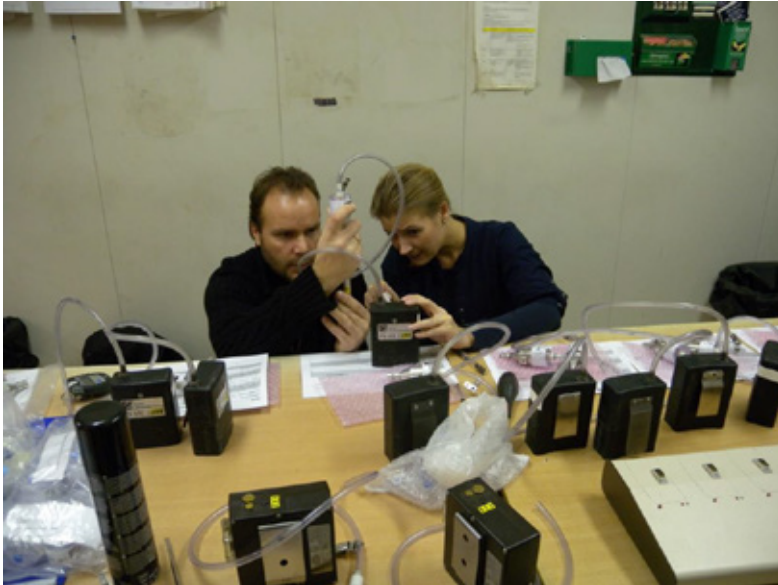
Figur 2: Kalibrering og oppsett for hovedeksponeringen - steinstøv
