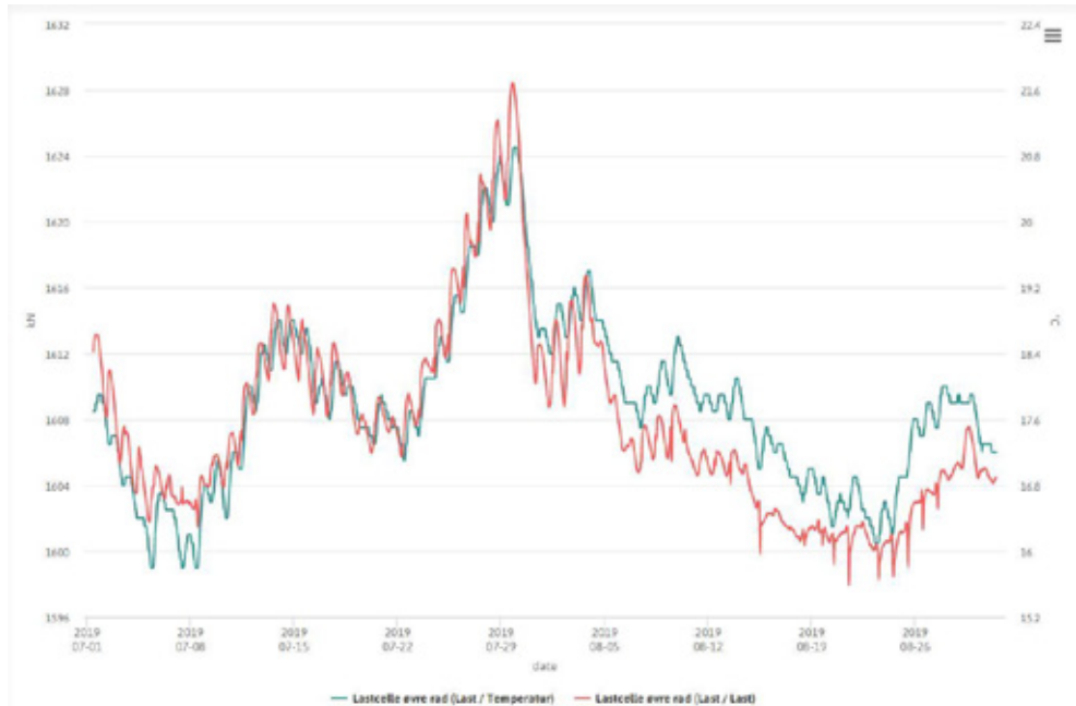
Figur 36: Viser last i kN for lastcelle i øvre stagrad mot temperatur internt i lastcellen fra juli til august 2019. Merk sammenfallende trend i økning av last mot økning i temperatur på en spesielt på en veldig varm sommerdag (29.07.2019).
