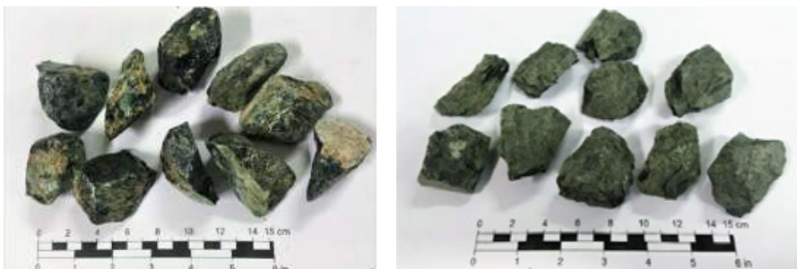
Figur 4: Preparerte prøver til slake-durability test; serpentinitt (venstre) og flysch (høyre)
