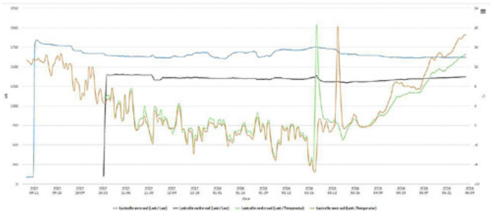
Figur 27: Viser utslag i kN og temperatur for lastcelle i øvre og nedre stagrad under etableringsfasen frem til juni 2018.
