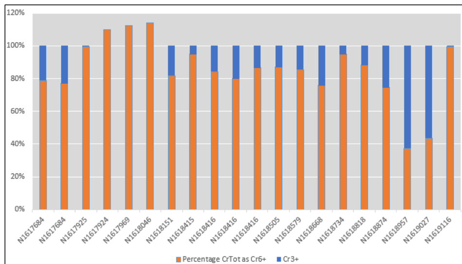
Figur 5 Andel CrVI utgjør av totalt krominnhold. Variasjonar og prosentandel over 100% illustrerer usikkerheita i prøvetaking og analyser.
