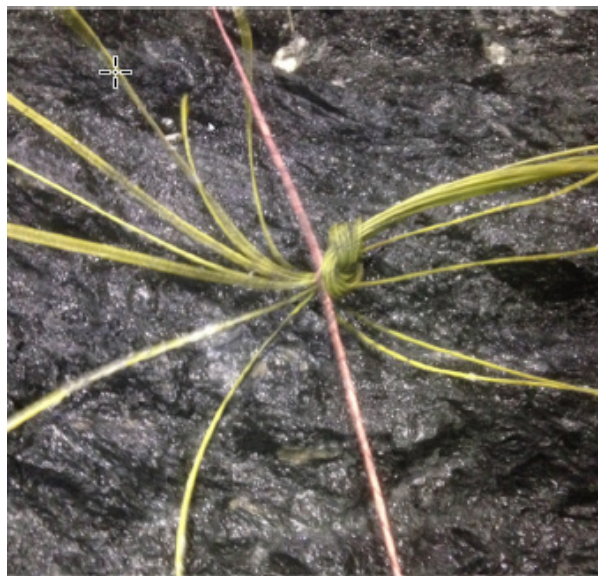
Figur 9. Ingen sikkerhetsavstand mellom lunte og bunt
