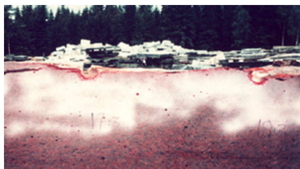
Skadesonen rundt konturhull med forsinkertid under 1 ms mellom hull [1]
