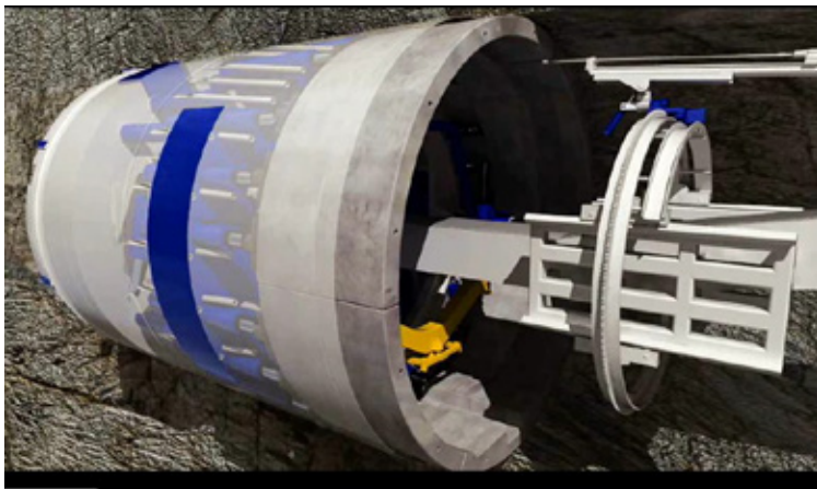
Figur 13 Plassering av borhammerne på en dobbeltskjold TBM (The Robins Company)
