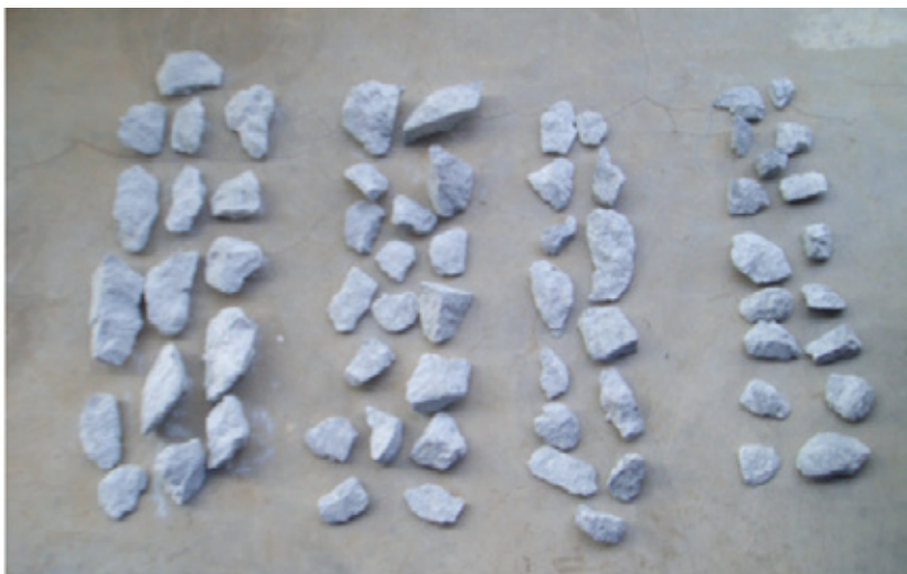
Figur 6 Borkaks fra samme bergmasse ved høy matekraft (venstre) og avtagende matekraft (midten og høyre). (Foto; Sindre Log)
