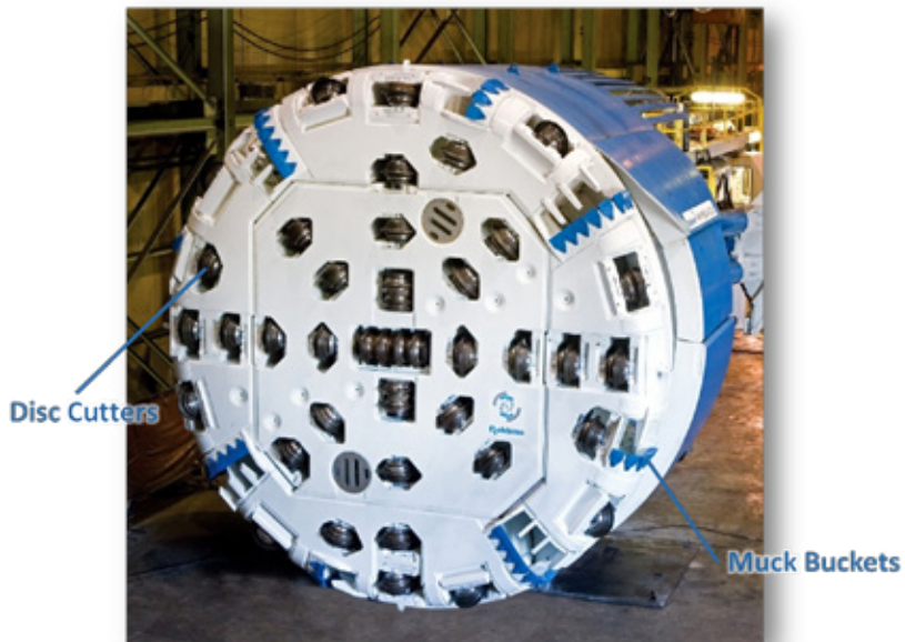
Figur 8 a) Kutterhode som viser diskcuttere som bryter berget, og skoper som transporterer berget gjennom kutterhodet og over på transportband (Foto: The Robbins Company)
