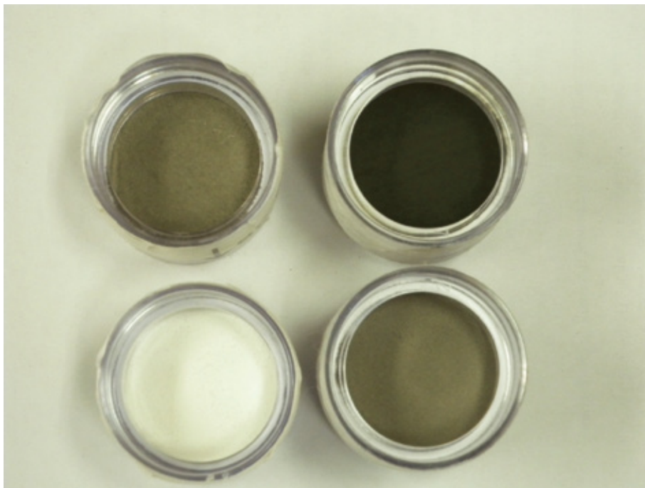
Bildet viser filter fra målinger i ulike arbeidsatmosfærer. Det mørkeste er benyttet i sjakt.
