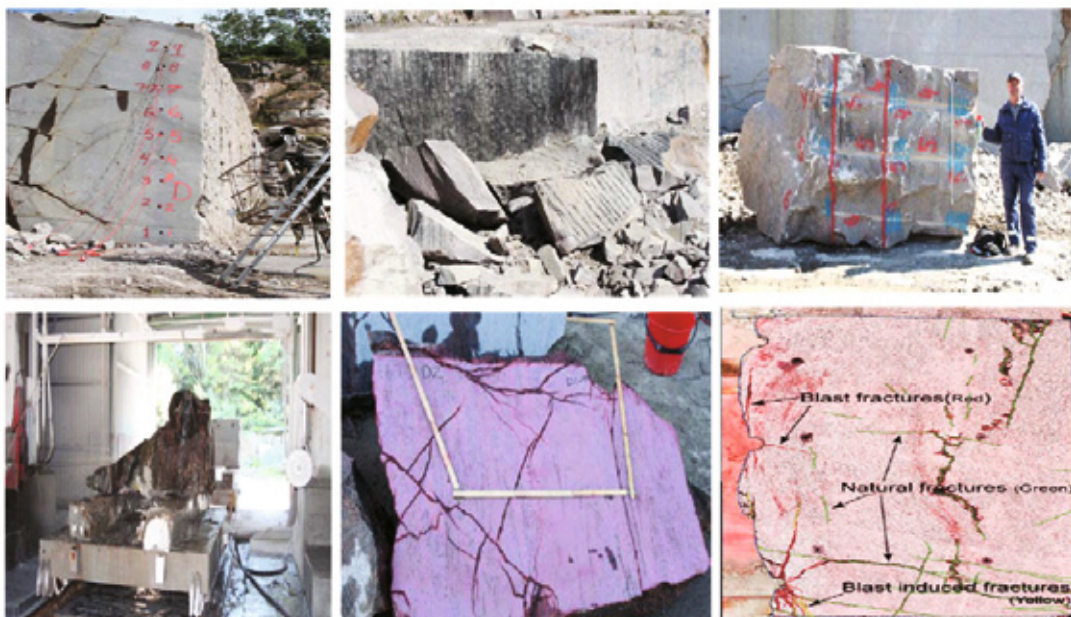
Figur 20. SveBrec's metode for måling av sprenginduserte sprekker. Forsøkshull bores, lades og sprenges. Konturen merkes med hull nummer. Uttak av blokker bak forsøkshull. Saging av blokker, påføring av penetrant på sagsnittene og kartlegging av sprekker.
