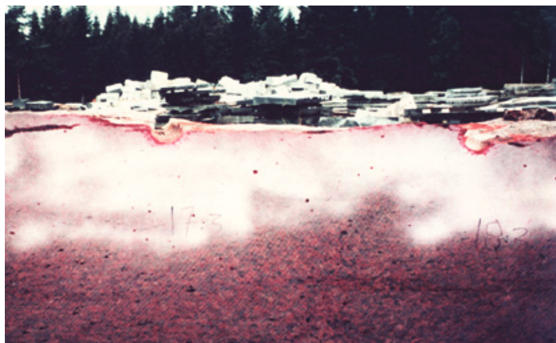
Figur 15. Ingen / liten skadesone mellom samvirkende ladninger mellom nabohull.
