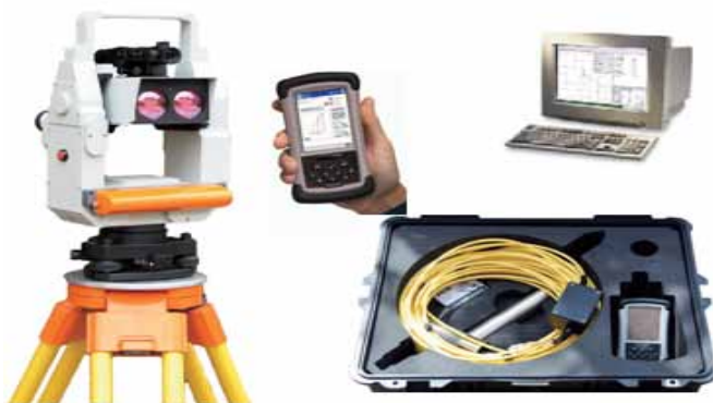
Figur 5.11. Utstyr for skanning av stoff og logging av borhull for kontroll av borhullsavvik
