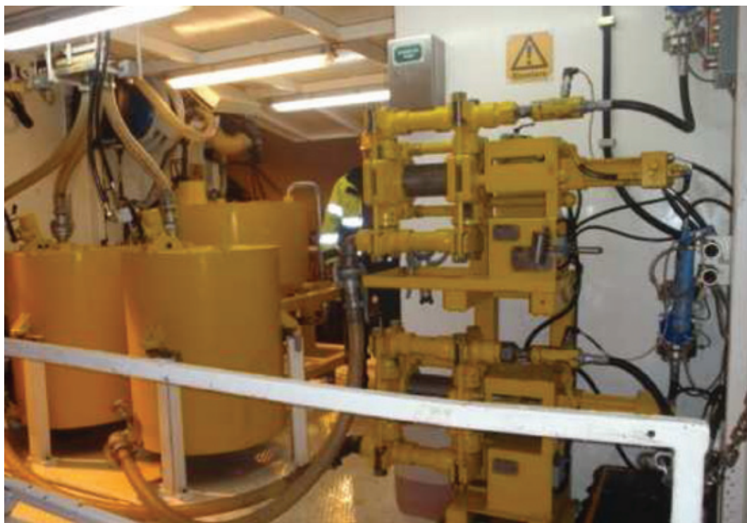
Figur 7 Eksempel på utstyr som inngår i en moderne injeksjonsrigg.
