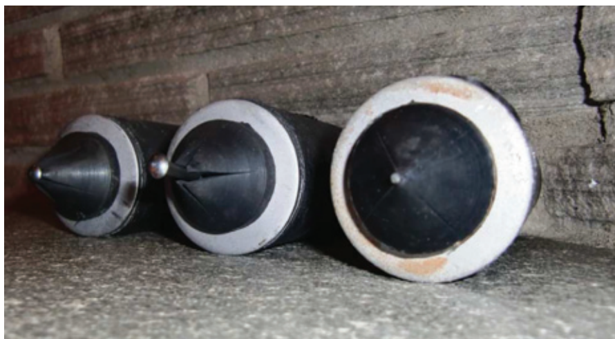
Figur 26 Pakkere som er åpne og slipper igjennom vann før det blir injisert
