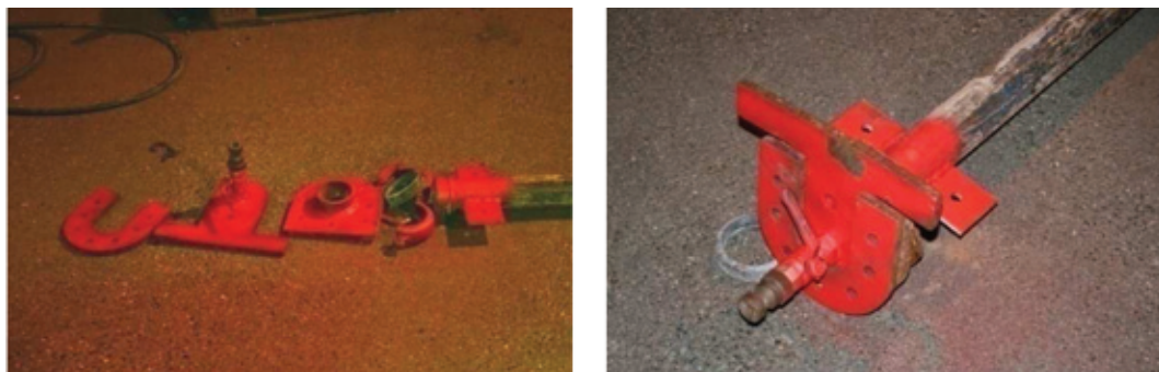
Figur 16 Elementene som inngår, og en sammensatt "Standpipe" stav.
