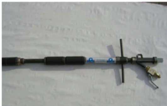
Figur 11 Høytrykspakker med hydraulikkran og festeøyre for kjetting til venstre og en sikkerhetspakker med ekstra oppstramming på selve lansen til høyre (demoversjon med forkortet stav).
