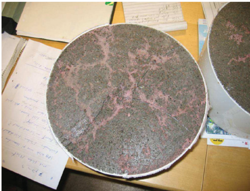
Figur 41 Forsøk som viser spredning av polyuretan.
