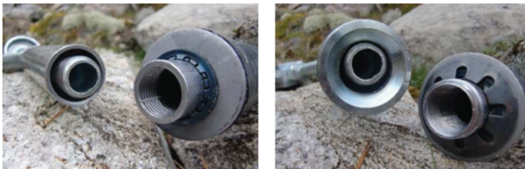
Figur 9 Pakkere med sete for inntil 60 bar til venstre og inntil 100 bar til høyre.
