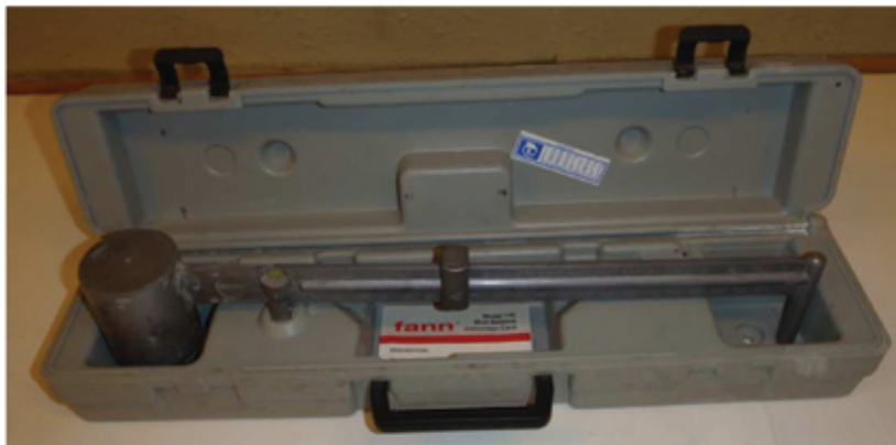
Figur 31 Standard utrustning for kontroll av v/c-tall, "mud-balance".
