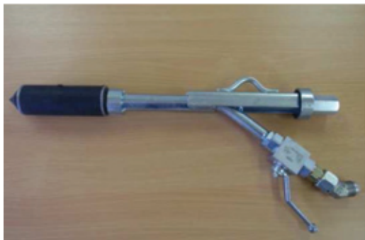
Figur 11 Høytrykspakker med hydraulikkran og festeøyre for kjetting til venstre og en sikkerhetspakker med ekstra oppstramming på selve lansen til høyre (demoversjon med forkortet stav).
