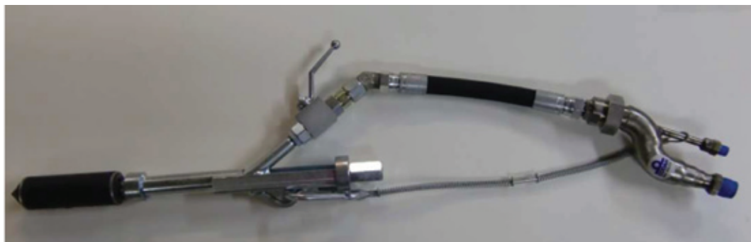
Figur 10 Komplette stav med akseleratormunnstykke (demoversjon med forkortet stav)
