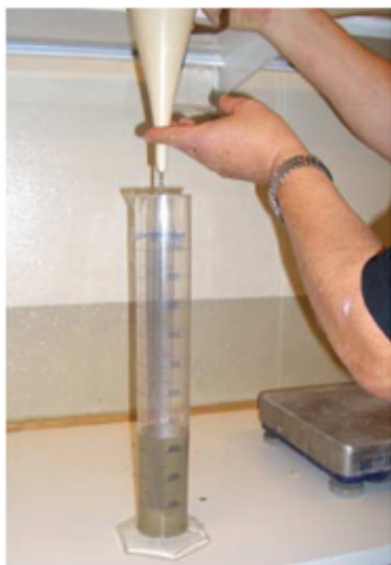
Figur 32 Kontroll av v/c-tall med bruk av Marsh-cone
