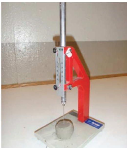
Figur 33 Vicat nål til testing av størkning
