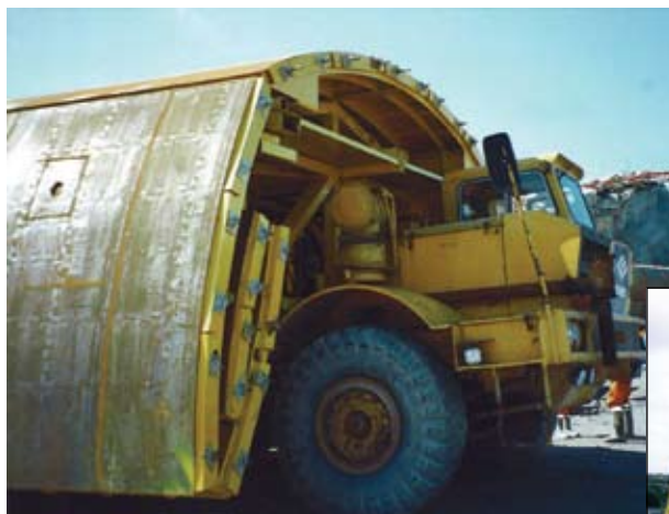
Figur 20. Eksempel på støpeskjold montert på dumper som ble benyttet på Frøyatunnelen
