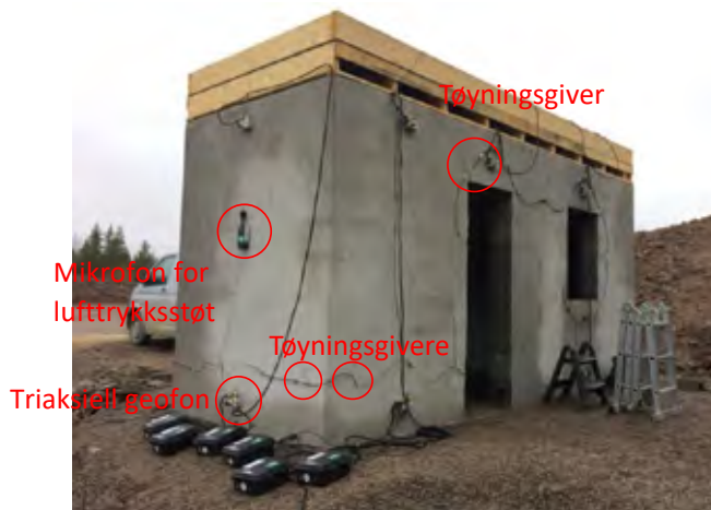
Figur 5. Instrumentering av Lecabygget
