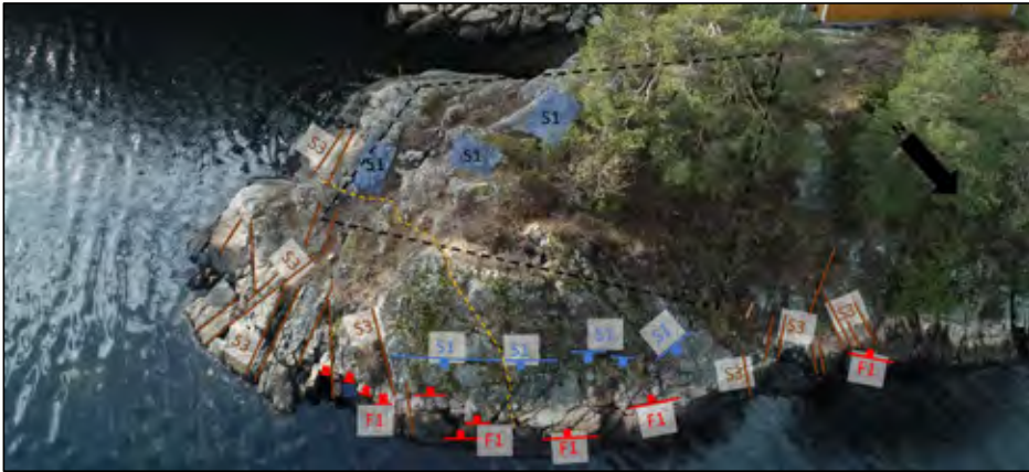
Figur 5: Illustrasjon av kartlagt oppsprekking i dagen ved fundamentområdet i akse 3. Bilde sett fra øst mot vest. Ca. fundamentplassering inntegnet med sort stiplet strek (noe forvridd bilde, fundament er rektangulært).
