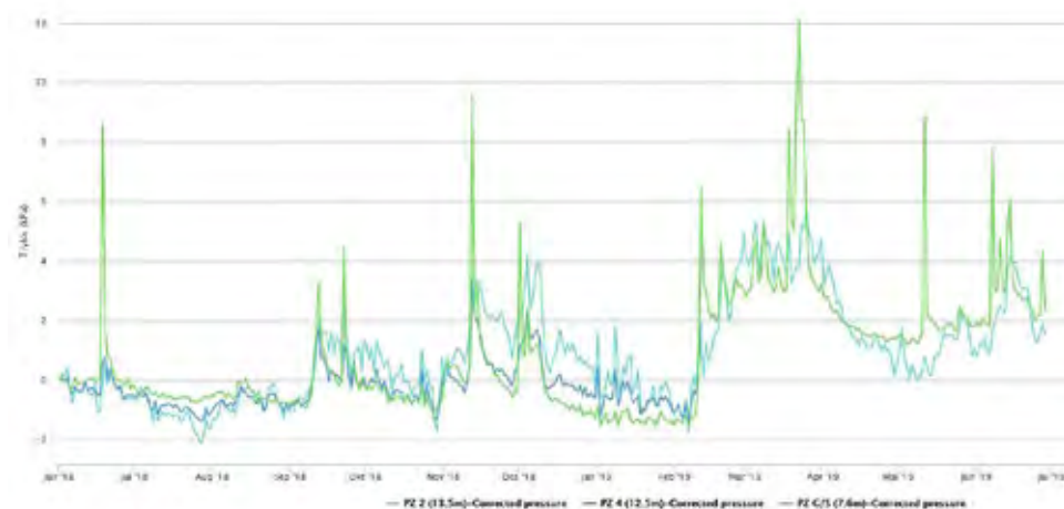
Figur 44: Viser endring poretrykk korrigeret for atmosfærisk trykk i permanent fase juni 2018 til d.d.
