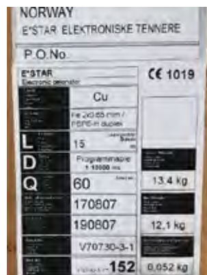
Figur 7. a) Lokalisering og nummerering av salvene. b) Spesifikasjon av sprengstoff og elektroniske tennere.
