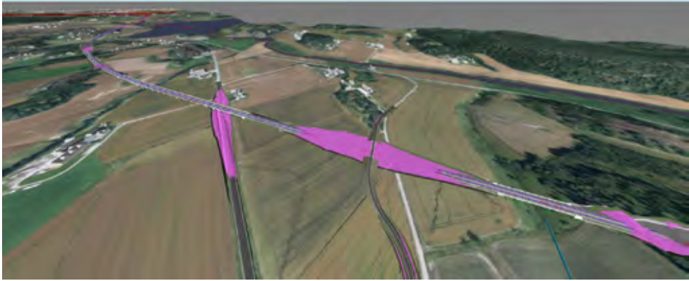
Figur 5: Utklipp fra sammenstillingsmodell, vist med terreng. Kalksementstabilisering er vist i rosa.
