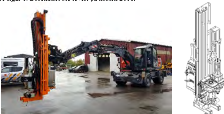
Figur 1 Bilde og skjematisk skisse av boretårnet.
