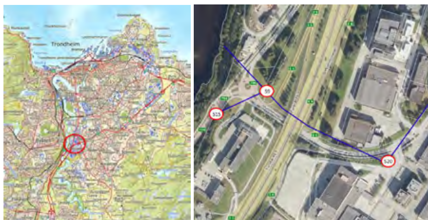
Figur 4: A) Aktuelt område. Nord oppover. B) Planlagt trasé langs Sluppenvegen. Figuren viser også omtrentlig plassering av aktuelle gropene i knekkpunkter. S15(mottaksgrop), S9 (pressgrop) og S20(mottaksgrop).
