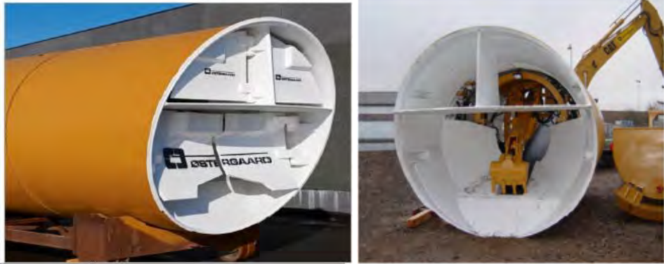
Figur 15: Borehode, åpen front med hydrauliske støtteklaffer– set forfra. /3/
