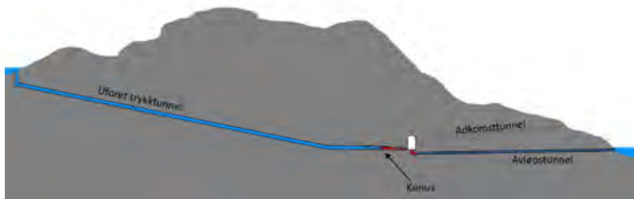
Figur 1: Idealisert lengdesnitt av et trykktunnelsystem med kraftstasjon plassert i berg.
