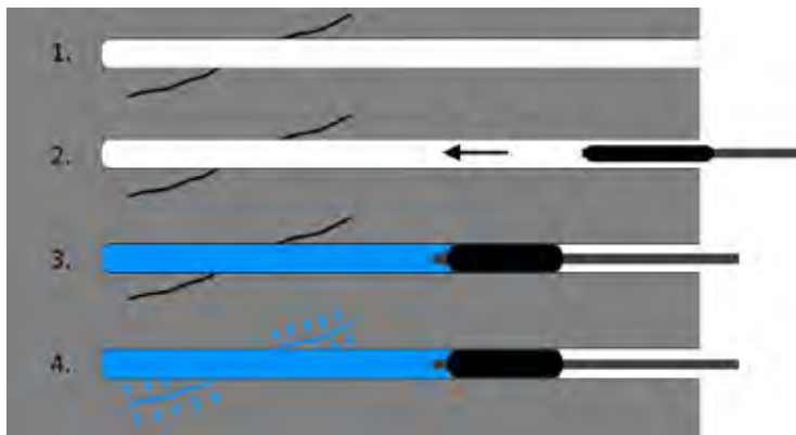
Figur 6: Prinsippskisse som viser en forenklet jekketest.
