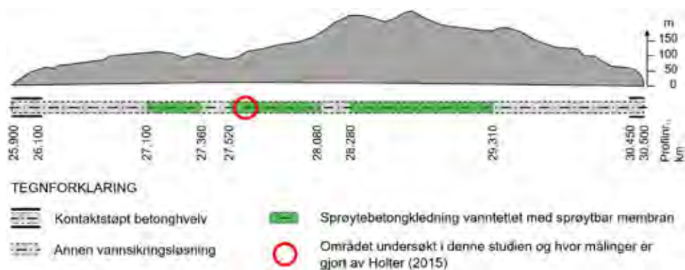
Figur 3: Lengdesnitt langs Gevingåstunnelen som viser områder der sprøytebetongkledning vanntett med sprøytbar membran er benyttet, samt området som studeres i denne artikkelen.
