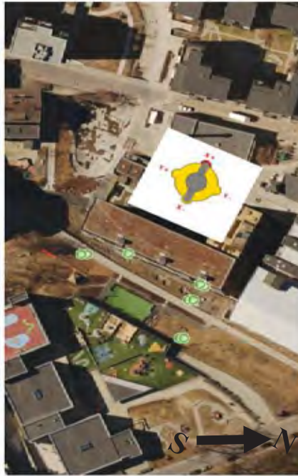
Figur 7: Viser XYZ storskala orientering av SAAF instrumentene i forhold til den etablerte spuntlinjen.
