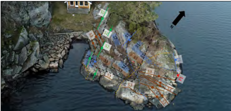
Figur 6: Illustrasjon av kartlagt oppsprekking i dagen ved fundamentområdet i akse 3. Bilde sett fra sørøst mot nordvest. Ca. fundamentplassering inntegnet med sort stiplet strek. Det går en ca. N-S strykende svakhetssone på innsiden/vestsiden av holmen, mellom holmen og berghammeren i vest.
