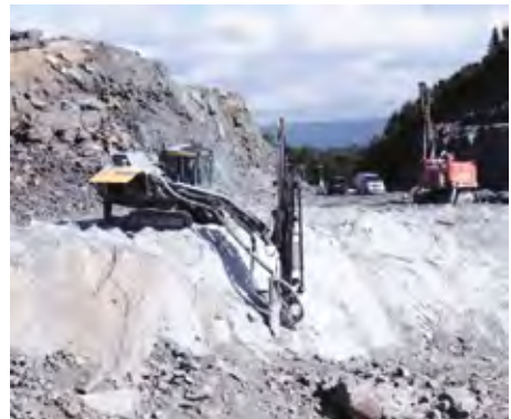
Figur 6 Boring med GPS-rigger fra både Atlas Copco og Sandvik.
