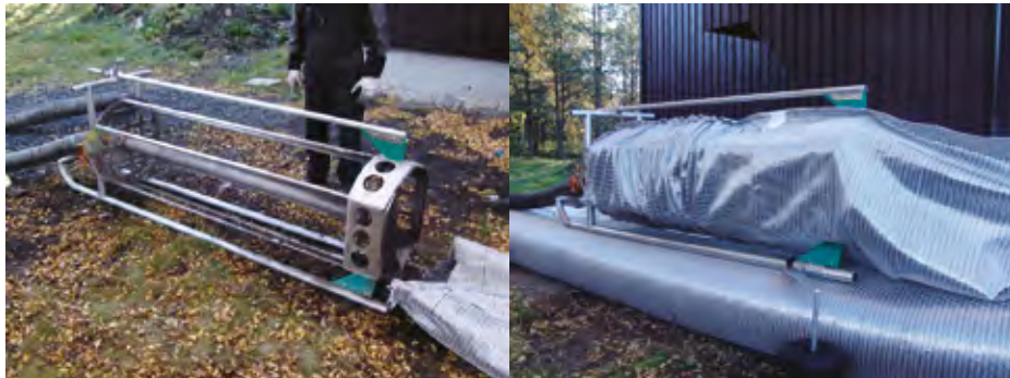
Figur 7 Prototype "slede" for innblåsing av Leca, 2010.
