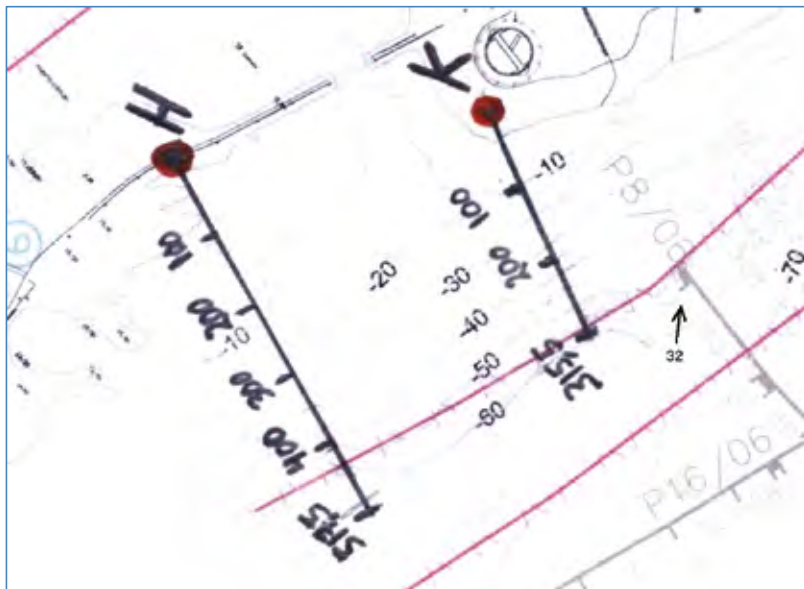
Figur 5 Nærbilde av Hesteholmen og Krågøy, og seismiske hastigheter fra refraksjonsseismikk i nærheten. Pilen viser at den seismiske hastigheten i nærheten er 3200 m/s (modifisert etter COWI, 2013).
