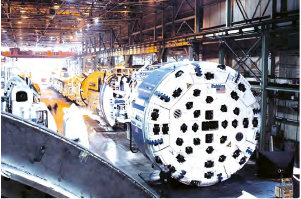
Figur 3 Foto av første gang TBM MB-263-308 ble montert sammen.
