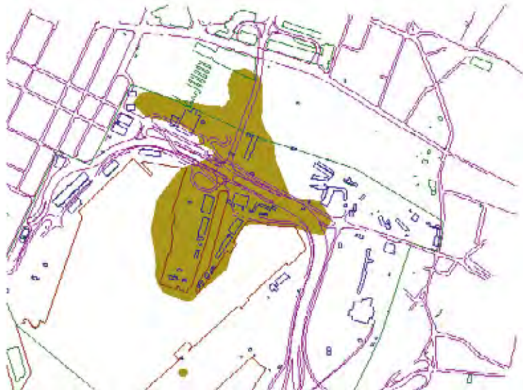
Figur 7 – Oversikt områder med sagflis i fyllmassene (etter NGI,2002)
