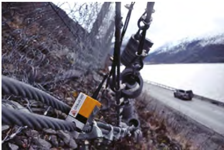
Figur 20. 4: Rystelsesmåler(e)i fanggjerdje ved riksveg 70 (Foto: SVV, 2013).
