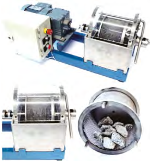
Figur 9. Test apparatur ved SINTEF/NTNU for bestemmelse av Slake-durability Index ( I_d ).
