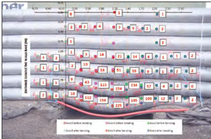
Figur 5 Deformasjoner i TEMaSi-konstruksjon ved fjerning av understøttelse for en seksjon (Górniak, J. 2013).
