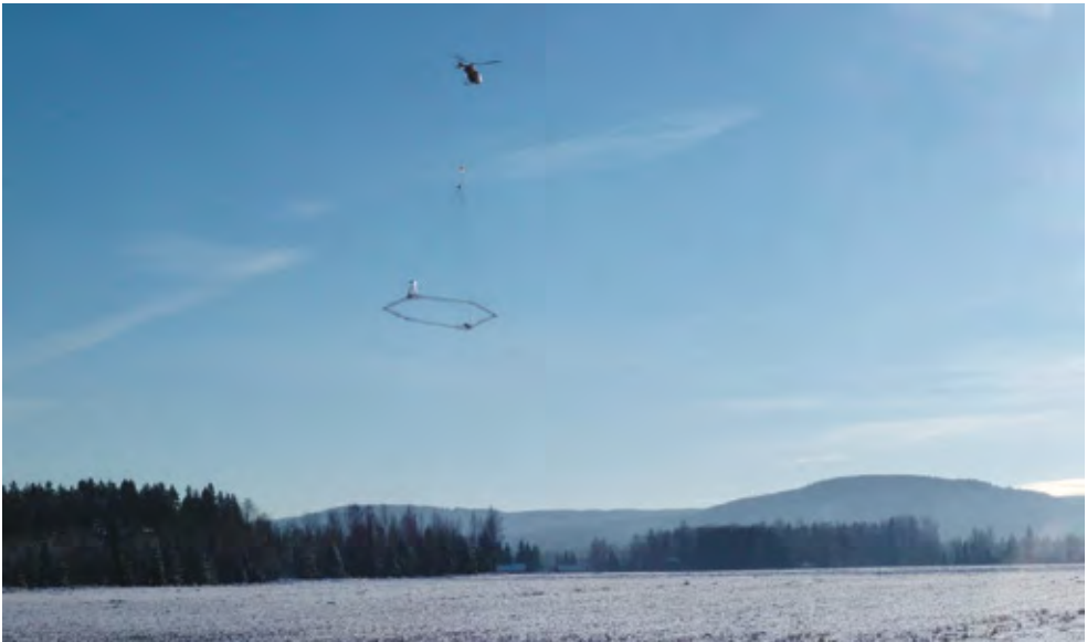
Figur 3: SkyTEM Airborne Electromagnetic survey langs E16, januar 2013
