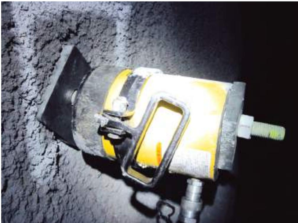
Bilde 7: Montert boltejekk med firkantet skive som stempelet trykker mot.
