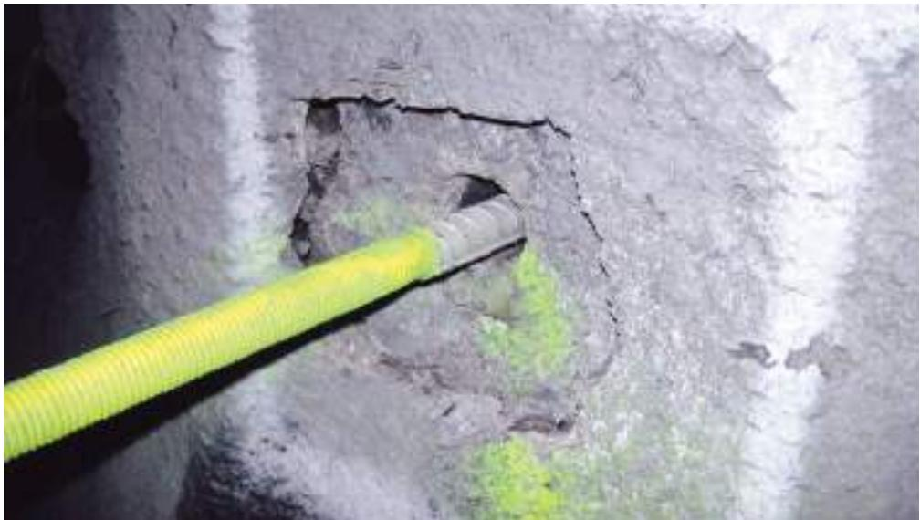
Bilde 8: Innpresset sprøytebetong, forsøksbolt FB11.
