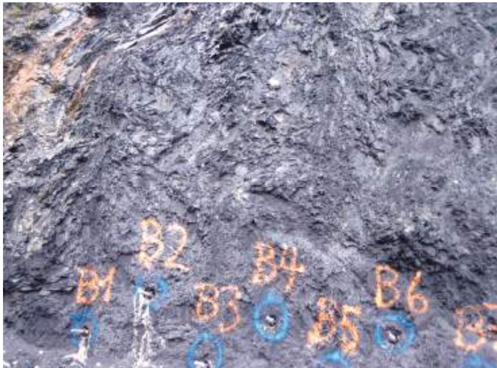
Bilde 4: Typisk bergkvalitet i bergskjæringen - småfallen og foldet alunskifer. Forsøksboltene er ferdig gyste.
