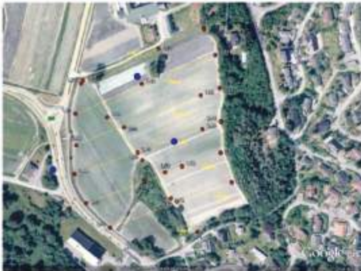
Figur 6 Resistivetsprofiler ved Linnes gård. Blå prikker indikerer påvist kvikkleire ved boringer.
