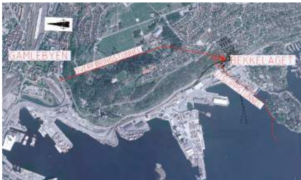
Figur 2. Oversikt over Delprosjekt A, Gamlebyen - Bekkelaget - Bekkelagsbassenget.
