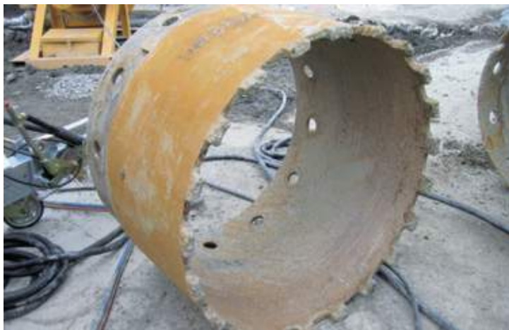
Figur15 Nederste del av borerøret. Merk tannkransen.
