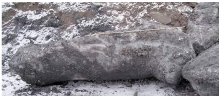
Figur 24 Betongklumper som ble gravd opp. Den lengste her er over 3 m lang.
