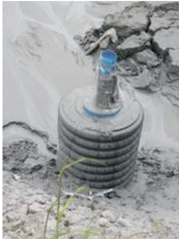
Figur 15 Bilde til venstre viser en prøve av sedimenter og vann som kom ut av brønn 302. Denne brønnen sto da for all synlig utvasking i området.
