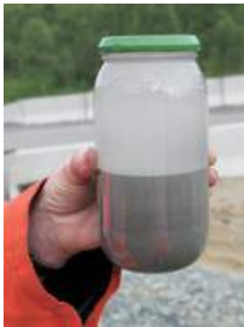
Figur 15 Bilde til venstre viser en prøve av sedimenter og vann som kom ut av brønn 302. Denne brønnen sto da for all synlig utvasking i området.
