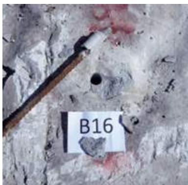
Figur 9 Bolt etter brudd med mørtelsøyle
