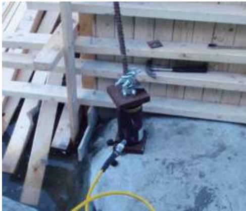
Figur 3 Typisk oppstilling ved prøvebelastning av bolt (R. Birkeland)
