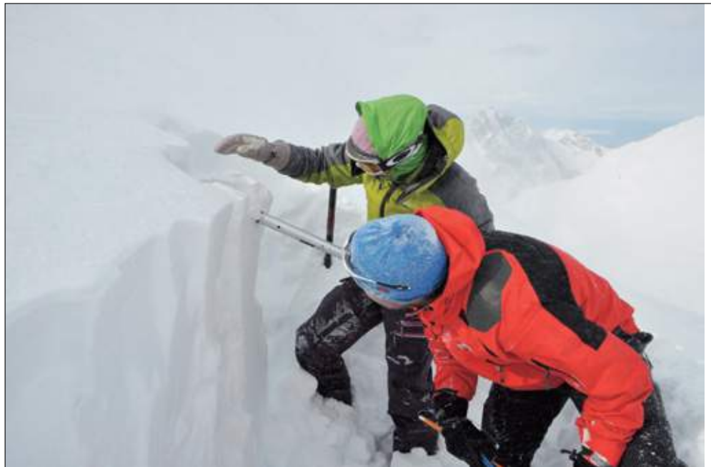
Figur 1: Kompresjonstest utviklet av Jamieson og Johnston (2002) utføres på isolert snøsøyle på 30x30 cm som ett av flere grunnlag for å definere faregrad i observasjonsområdet. Dette blir igjen ett av flere grunnlag som varslingsgruppa bruker for å fastsette en regional faregrad (foto: Tore Humstad)
