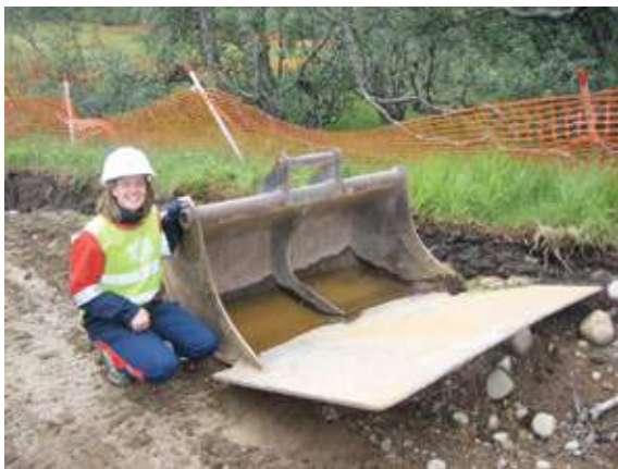
Figur 4: Skuffe til opptak av torver. Foto: P. A. Pedersen.
