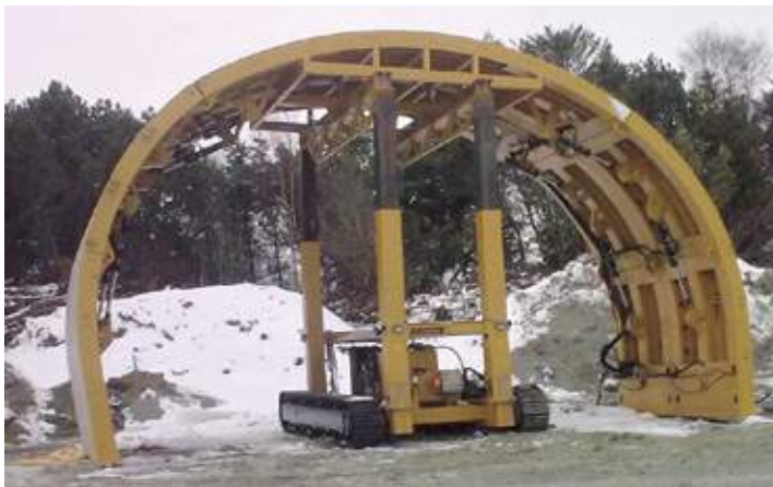
Figur 18-7 viser hydraulisk tunnelskjold som var mobilisert til prosjektet.
