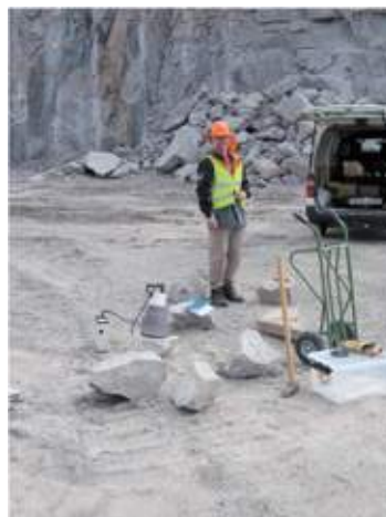
Figur 2. Målinger i granitt med gammaspektrometer.
