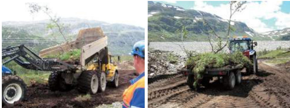
Figur 5: Traktor og dumper ble brukt til transport av torver med fjellbjørk. Svansen er spesiallaget. Foto. A. Søreide
