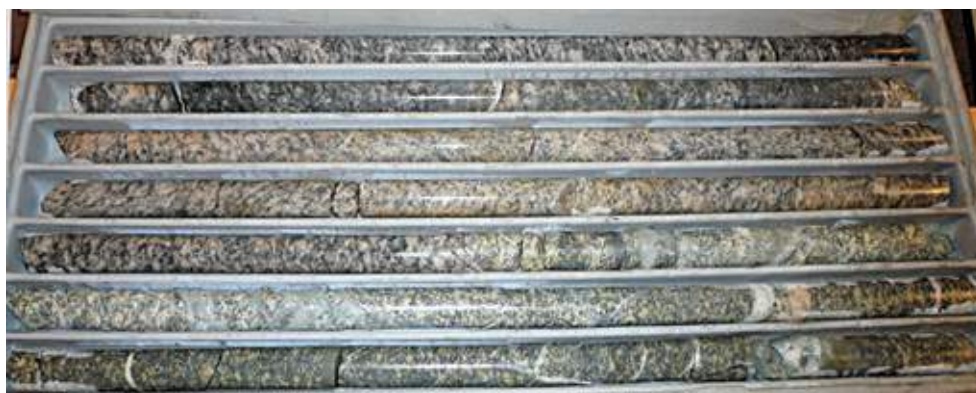
Figur 3. Borkjerner med delvis forvitret berg i nedre del.
