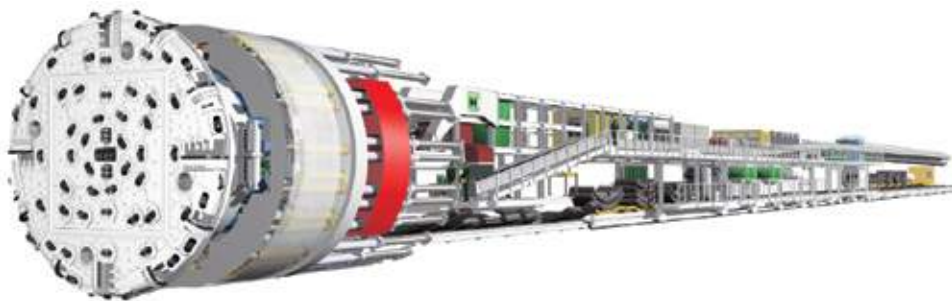
Figur 7. Dobbelskjoldmaskin (Illustrasjon: Herrenknecht 2011)
