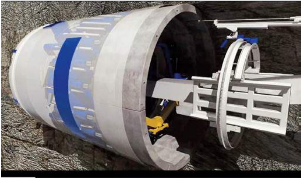
Figure 3 Plassering av borehamre på Dobbelskjoldete TBMer iii
