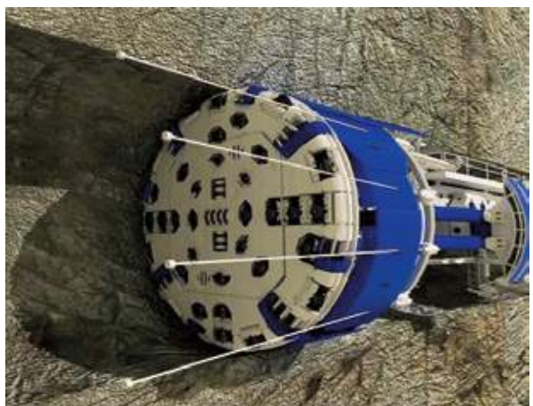
Figure 4 Boring for injeksjonsskjerm
