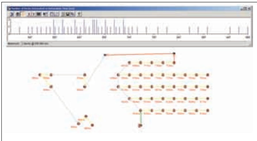
Fig.15. Monte Carlo-simulering, salve 2 med tenningsstider og tidskonturlinjer. Staplene viser at det inntreffer overlapping i tennsystemet i området 595-795 ms
