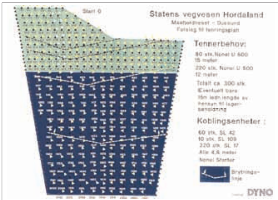
Fig.10. Tenningsplan for tilnærmet ethullstening for salven på Duesundøya. Forsetningstid 84 ms. Hullavstandstid 17 ms. Opptenningens varighet ca. 2100 ms.
