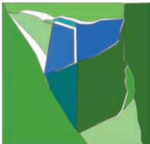
Figur 8 ”Dårlig” modell for Åkneset basert på forskyvninger målt i perioden 2004 – 2006 som er skalert opp med 500. Røde prikker angir målepunkter. Størrelsen på tilhørende vektor angir avviket mellom målt (input) og beregnet forskyvning i målepunktet.
