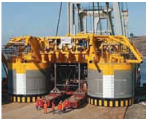
Figur 3. Template for installering på Ormen Lange
