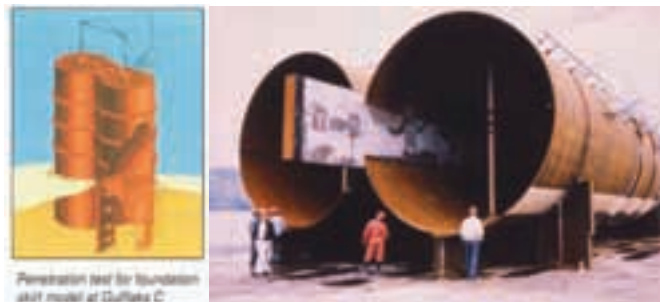
Figur 7. Modell for testing av sugepenetrasjon av skjørteelement på Gullfaks C
