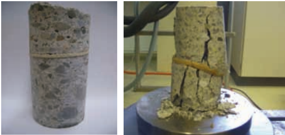
Figur 1. Sprøytbar vanntetningsmembran Masterseal ® 345 i kontinuerlig sandwichstruktur med sprøytebetong. Bildet til høyre viser at den mekaniske fastheten til denne sammensatte strukturen er betydelig. Ved spenninger som gir brudd i sprøytebetong er membranen istand til å ta opp deformasjoner uten at hele strukturen går fullstendig til brudd.
