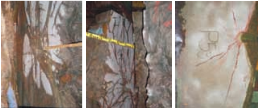
Figur 3. Sågsnitt med framkallade sprickor från skonsamt sprängda konturer.
