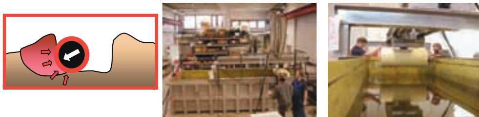
Figur 6. Modelltank ved NGI for testing av stor diameter rør i neddykket tilstand
