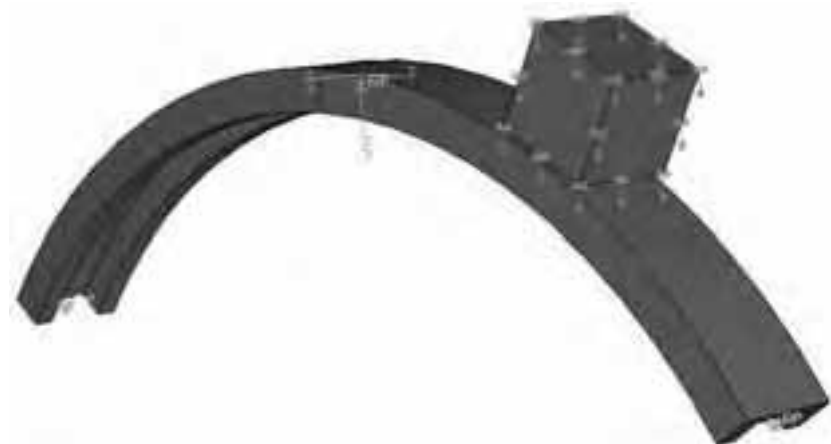
Figur 18.2 Illustrasjon av randbetingelser for beregningsmodell
