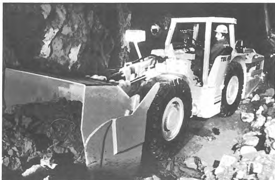
Fig. 10-3. Opplastningen starter med skuffene samlet.
