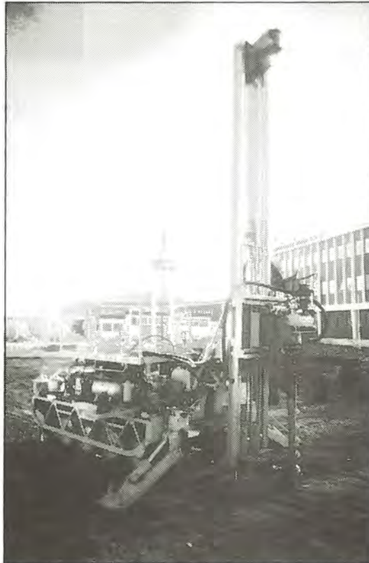
Fig. 33-3. Borrygen «Tor» med utstyr for trykksondering, prøvetaking og fjellboring.
