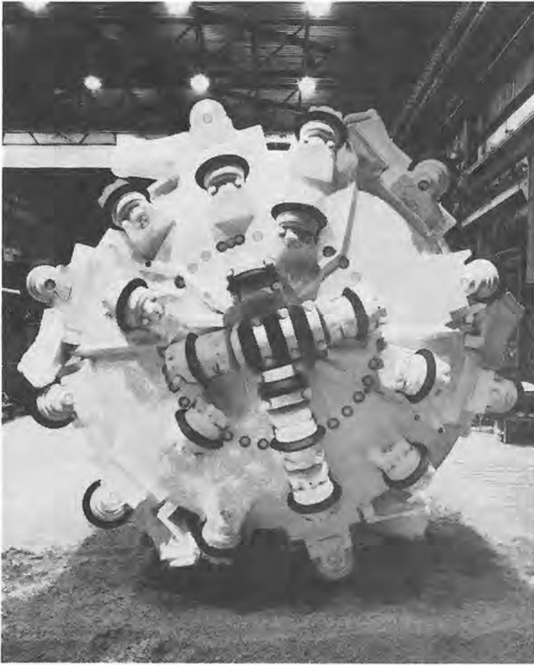
Fig. 3-4. Borhode med 1 tridisc og 23 enkle disc-cuttere.
