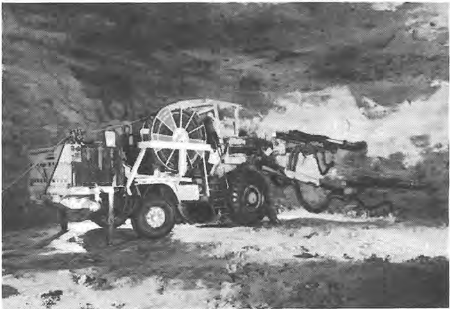
Fig. 2-1. Atlas Copco's Boomer H-132 med 2 hydrauliske bormaskiner Cop 1038 HD.
