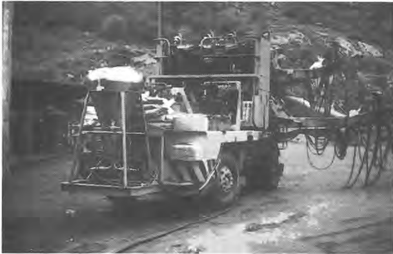
Fig. 6-1. Rigg med ladeutstyr.
