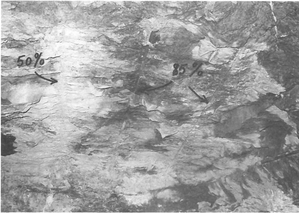
Fig. 3-2: Gjenstående borpiper etter sprengning med 50% (til venstre) og 85% polystyrentilblanding.
