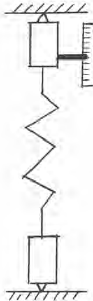
Fig. 13—4 Prinsipp for passiv målecelle.
