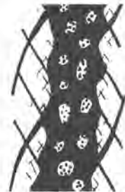
Fig. 17-6 Enkel leirrik knusningssone.
