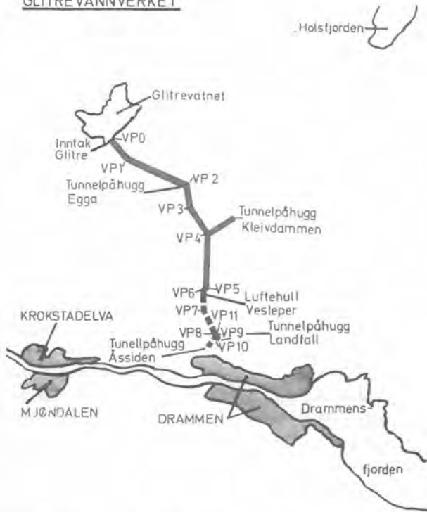
Fig. 8-1 Trase for overføring av drikkevann fra Glitrevatnet til Drammen.
