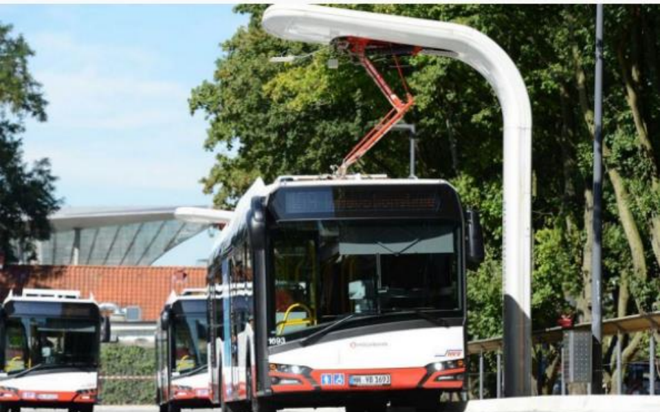
LADESTASJONER. Enova støtter elbussprosjektet i Trondheim med 15 millioner kroner til ladestasjoner, såkalte pantografer i hver ende av de fem linjene. FOTO: SIEMENS
