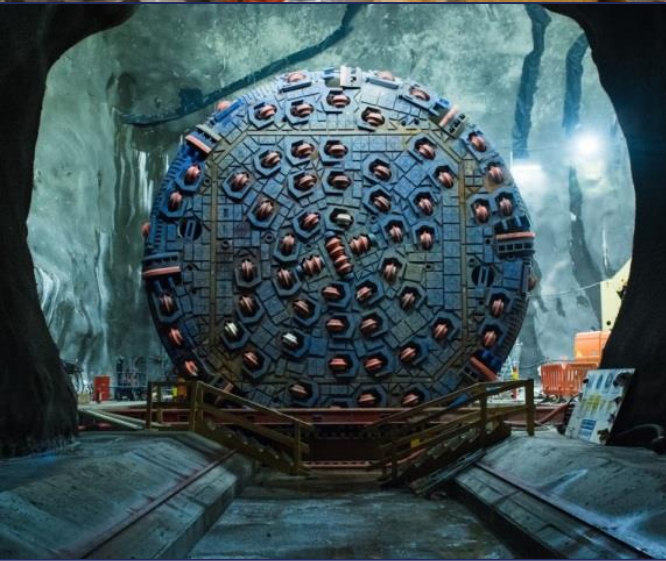
| Fire tunnelboremaskiner (TBM) som er skreddersydd for harde norske bergforhold (Herrenknecht) BANE NOR
