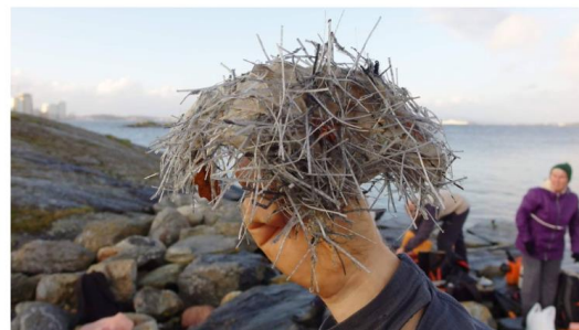
Dette er plastfibre som brukes til armering i sprøytebetong. FOTO: ERIK THORING / NATURVERNFORBUNDET I ROGALAND
