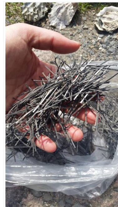
Har du sett slike grå striper på stranden og lurt på hva det er? Dette er plastarmeringsfibre, som frem til nylig ble brukt i sprøytebetong. Hvor store mengder som finnes av slike plastfibre langs kysten, er uvist. Stille viser plastavfall funnet på huk i indre Oslofjords strandryddesdagen 2016. (Foto: Jonette von Krogh)
